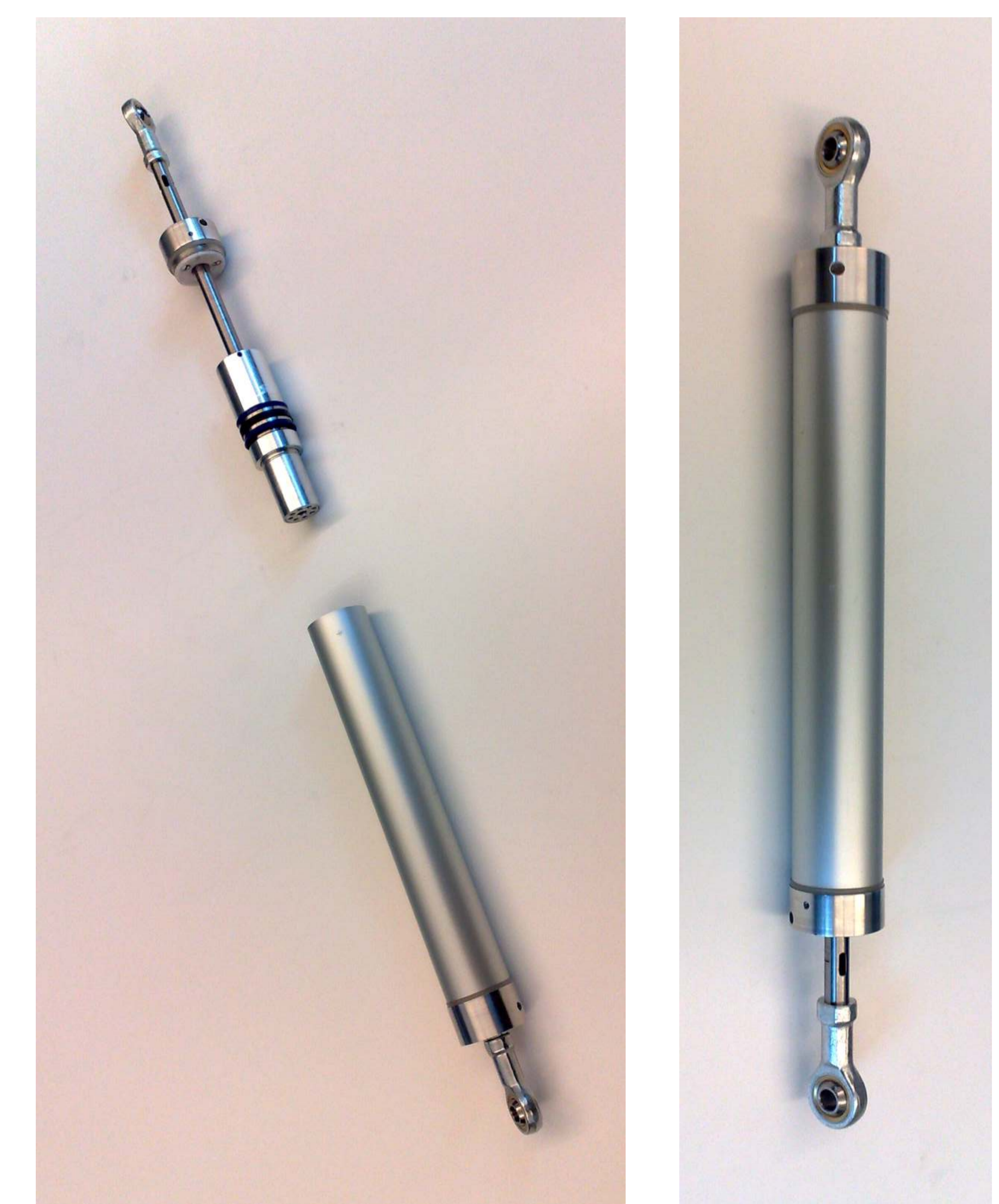
Rys. 8. Pneumatyczny Adaptacyjny Absorber PAA Fig. 8. Pneumatic Adaptive Absorber PAA
