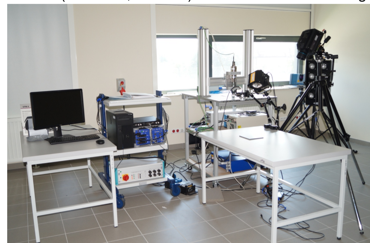
Rys. 1. System aktywnej termografii do badań niszczących Fig. 1. Active thermography system for non-destructive testing
