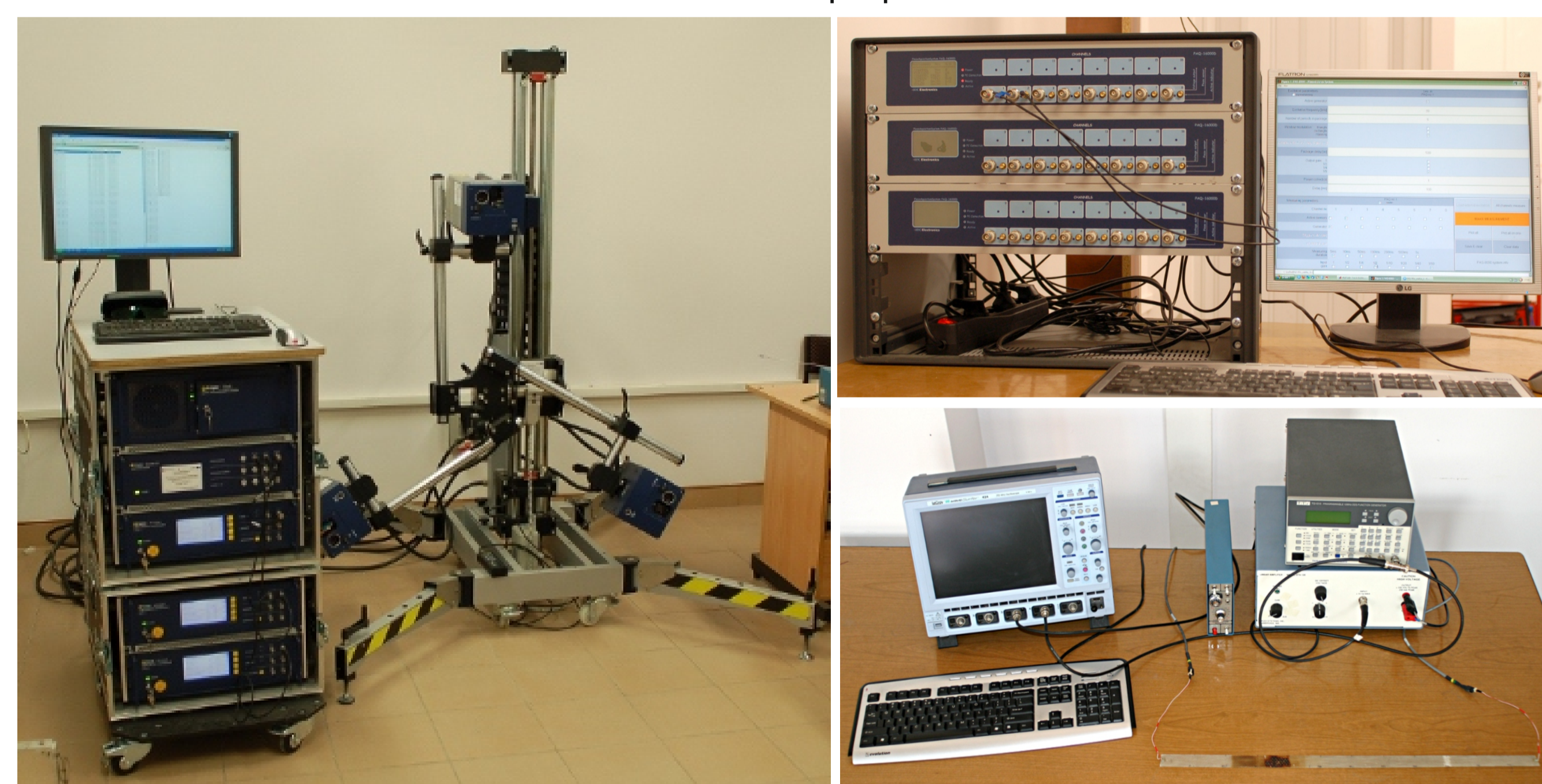
Rys. 3. Aparatura umożliwiająca pomiary propagacji fal sprężystych: a) wibrometr laserowy, b) system PAQ 16000D, c) zestaw z oscyloskopem cyfrowym LeCroy Fig. 3. Equipment that enable measurement of elastic wave propagation: a) LDV, b) Phased array acquisition system PAQ 16000D, c) digital oscilloscope LeCroy.
