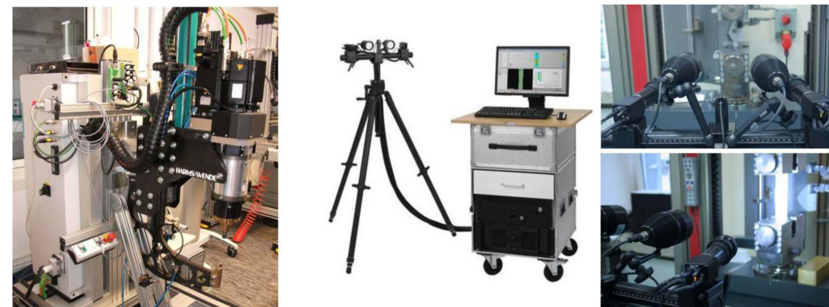
Rys. 3. Maszyna do zgrzewania RFSSW firmy Harms & Wende Fig. 3. Harms & Wende RFSSW welding machine
