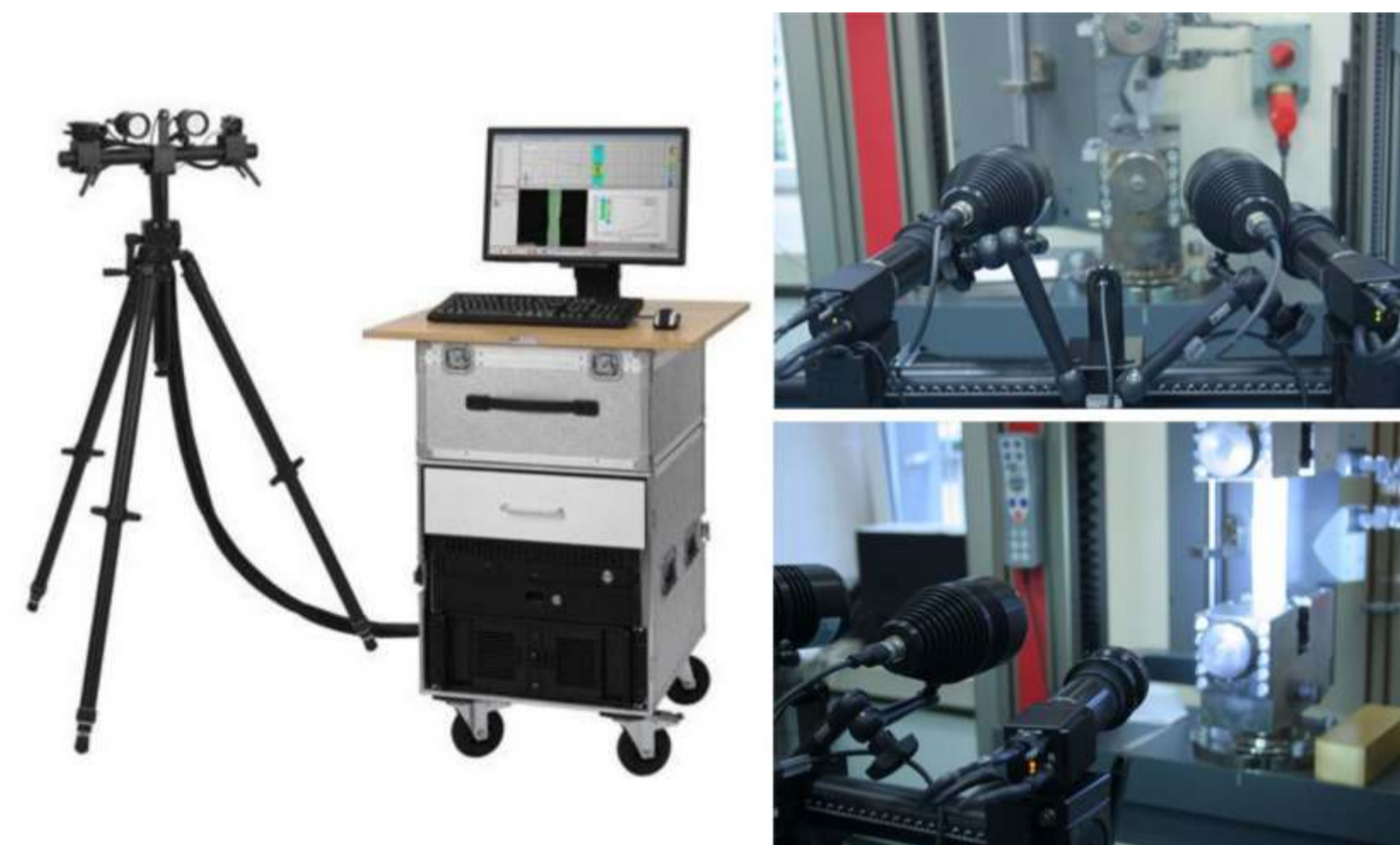
Rys. 4. Próba rozciągająca złączy FSSW za pomocą maszyny wytrzymałościowej z systemem analizy optycznej, Aramis Fig. 4. Tensile test of FSSW joints using testing machine with 3D optical analysis system, Aramis
