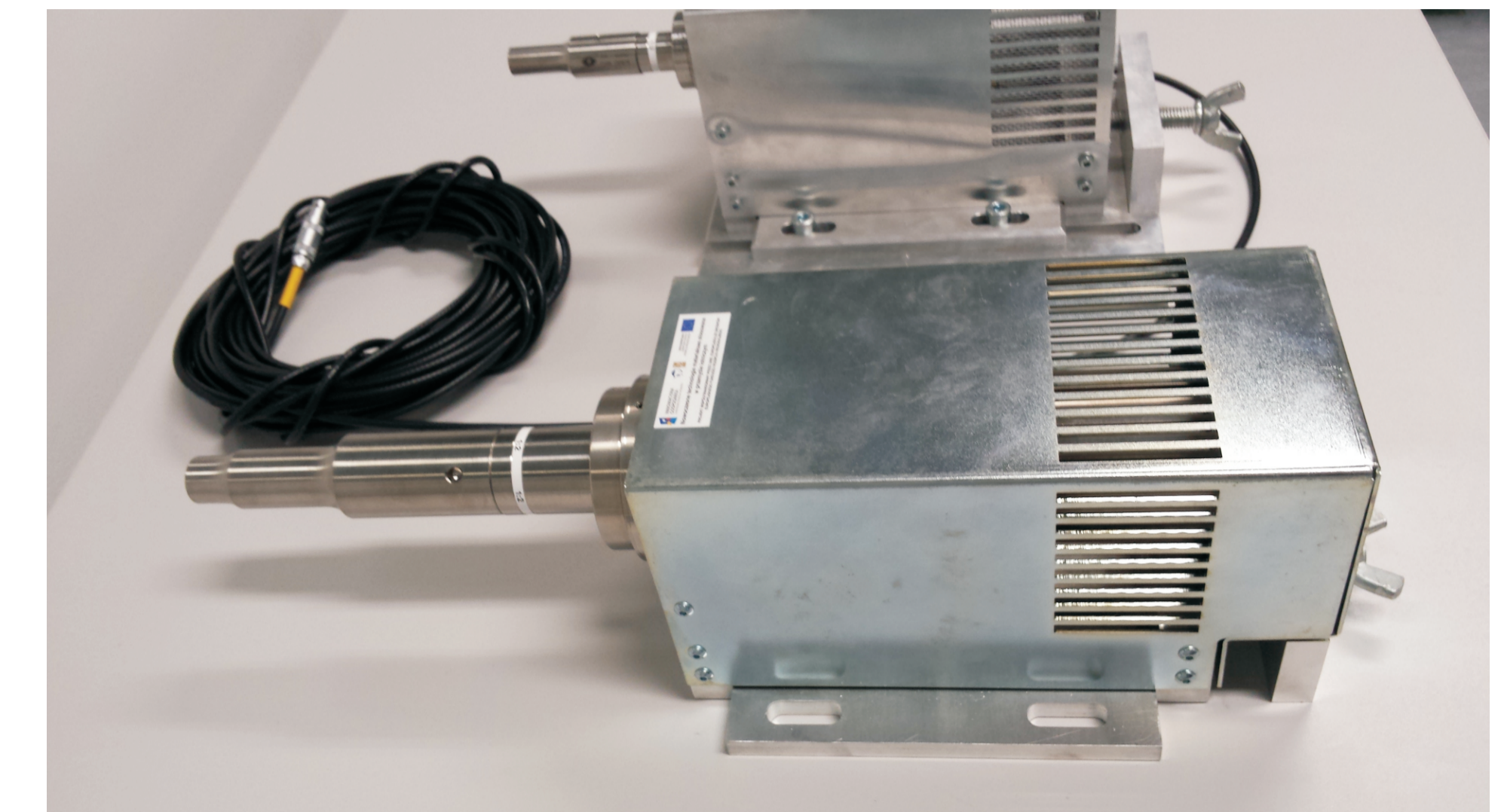
Rys. 9. Sonotroda układu wzbudzenia przedmiotu obrabianego Fig. 9. The sonotrode of the workpiece excitation system
