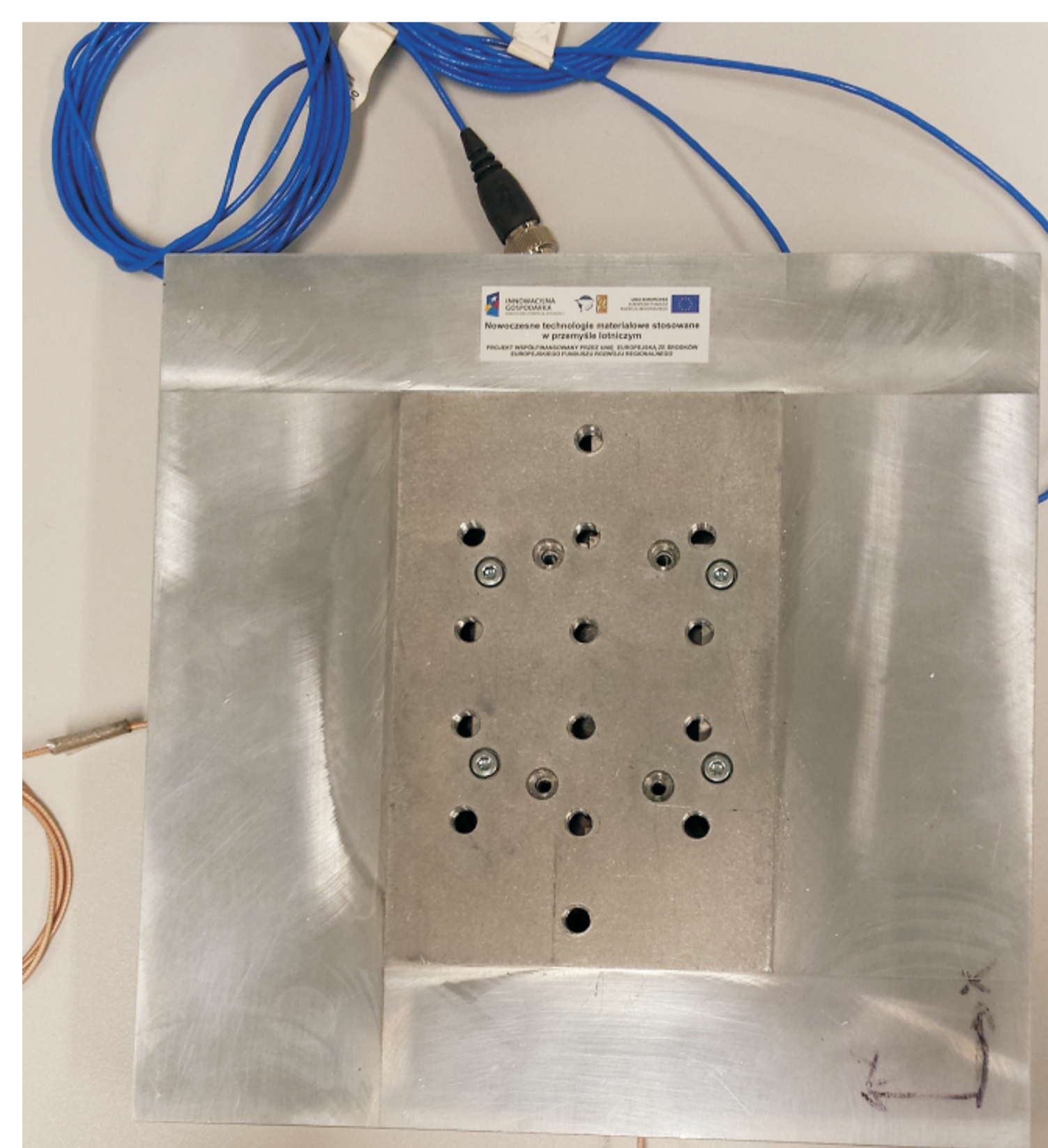
Rys. 7. Aktywny uchwyt obróbkowy Fig. 7. The active holder
