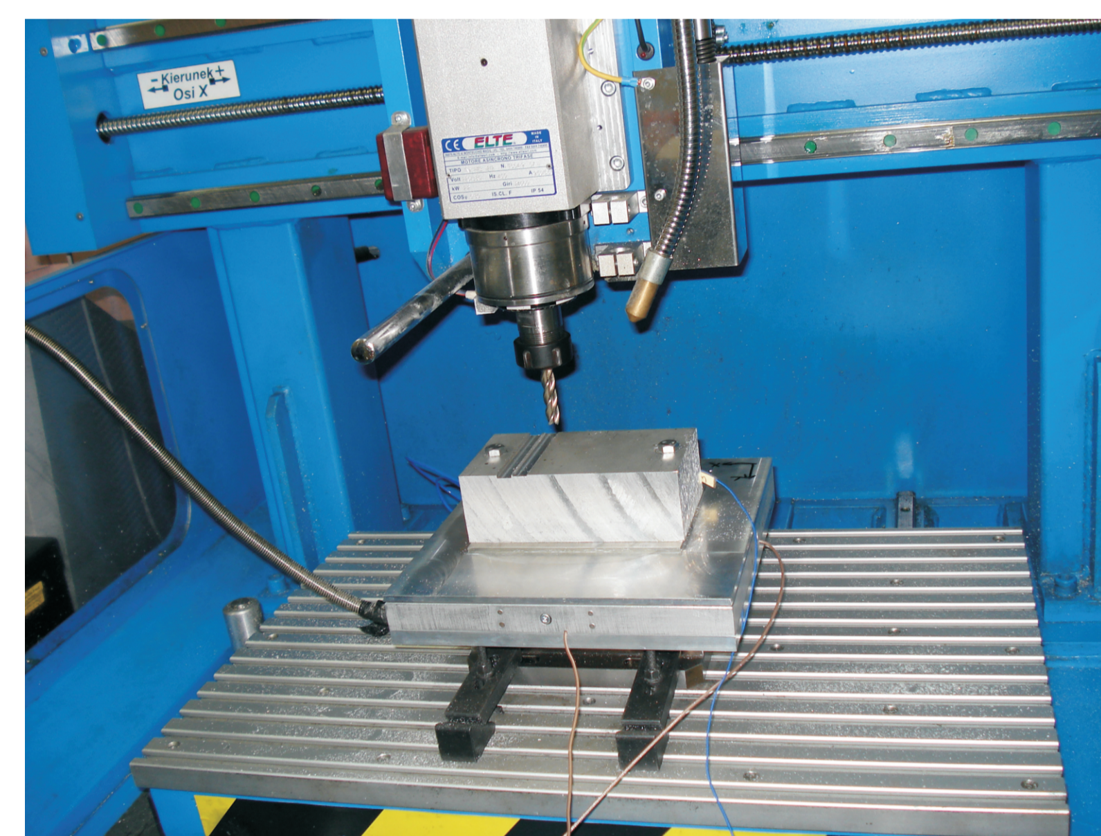
Rys.5. Stanowisko testowe aktywnego uchwytu obróbkowego Fig.5. The test stand of active holder
