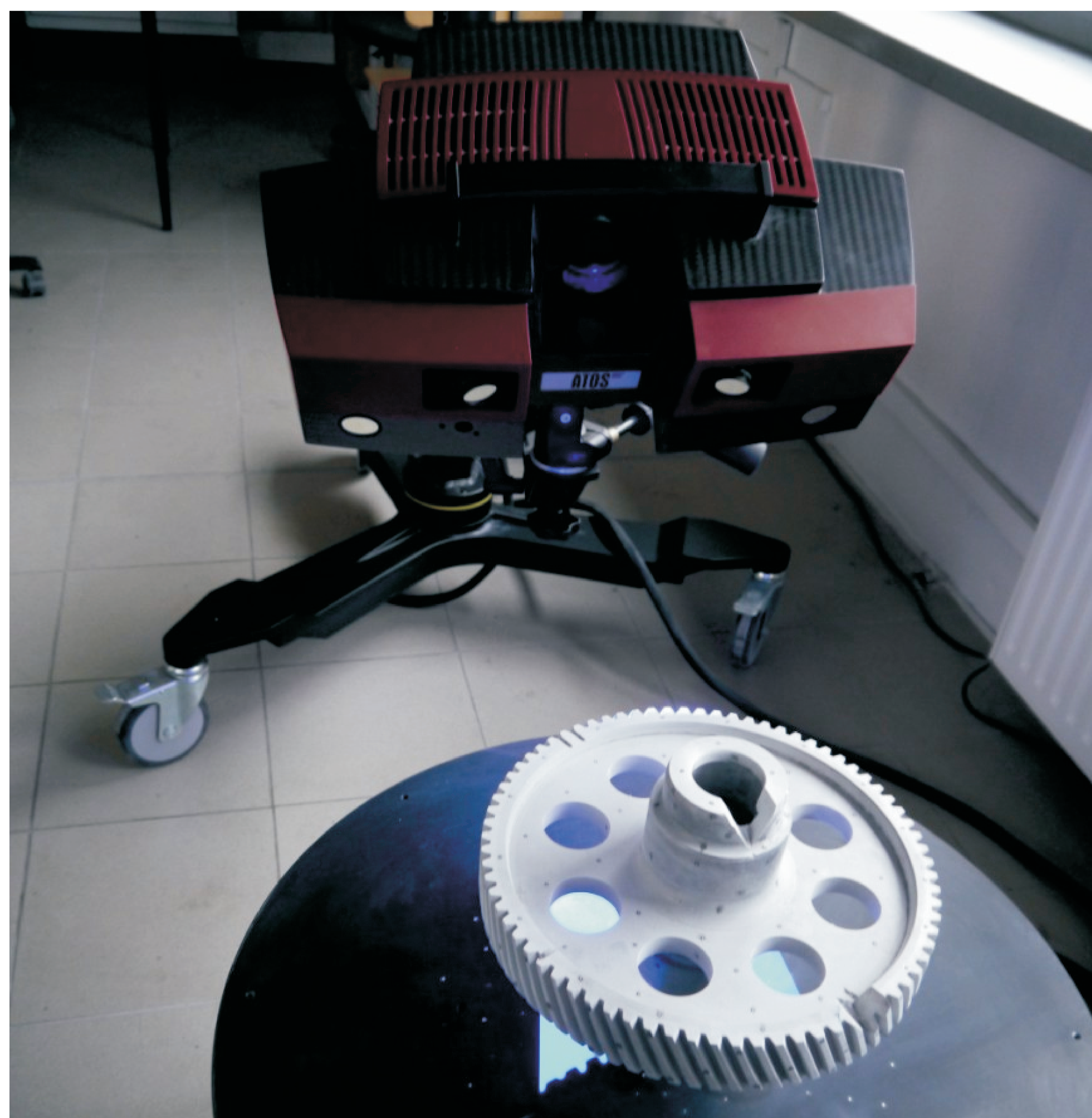
Rys. 1. Pomiar walcowego koła zębatego lotniczej przekładni dwudrożnej prowadzony z zastosowaniem optycznego skanera 3D ATOS II TripleScan Figure 1 Measurement of the spur gear from aeronautical dual-path gearbox performed using a 3D optical scanner ATOS II TripleScan
