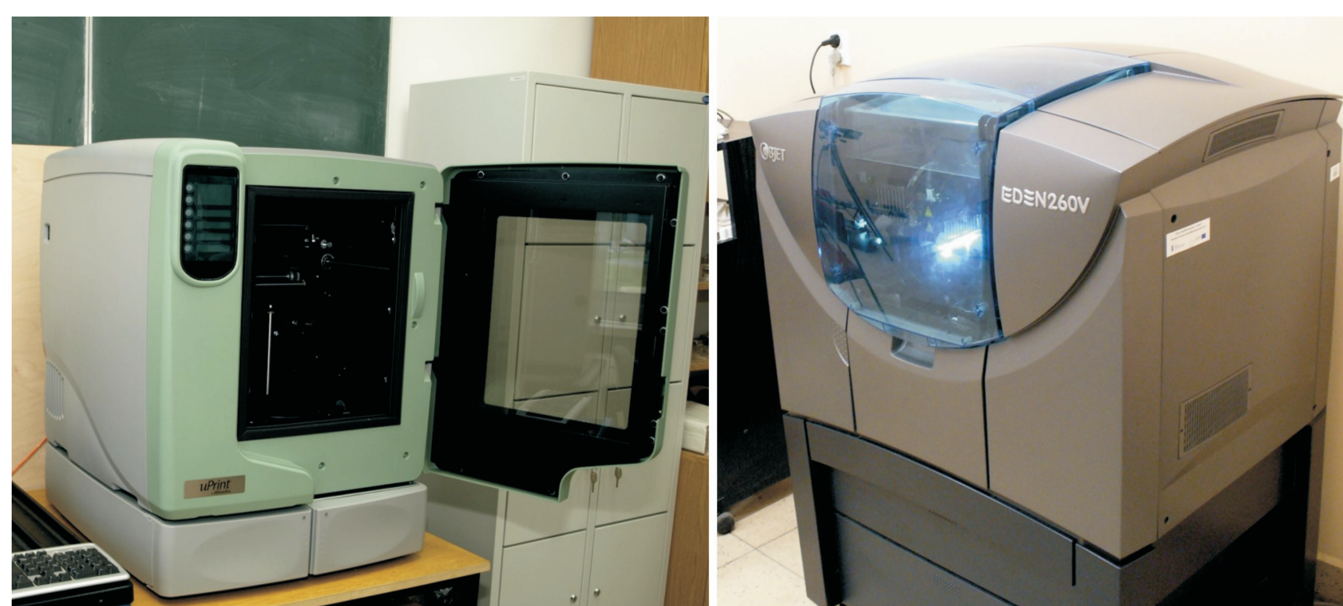
Rys. 2. Przykładowe urządzenia służące do szybkiego prototypowania z zastosowaniem przyrostowych technik wytwarzania U-Print oraz JS - PolyJet Figure 2 Examples of devices for rapid prototyping using incremental techniques for production called U-Print, and JS - PolyJet
