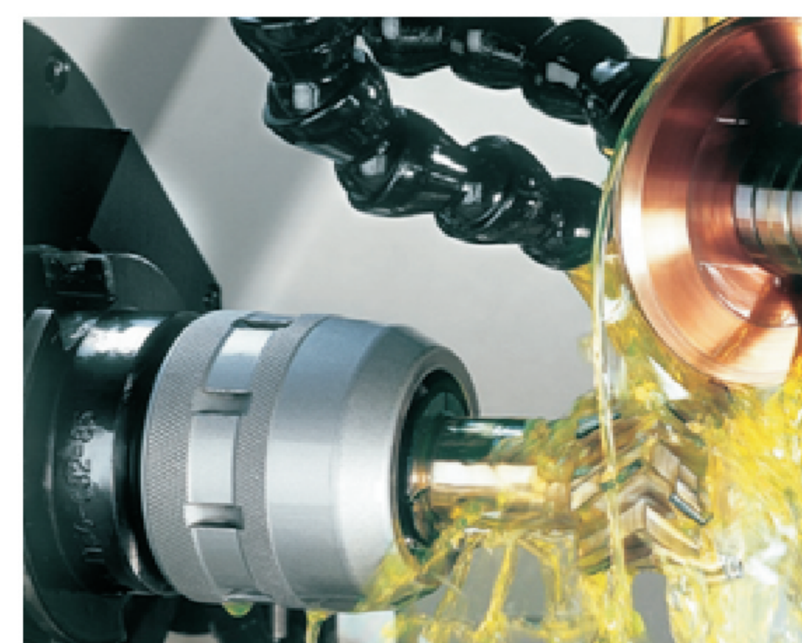
Technologia kształtowania ostrzy narzędzi specjalnych metodą elektroerozyjnej elektrodą obrótową. EDG technology of special cutting tool machining
