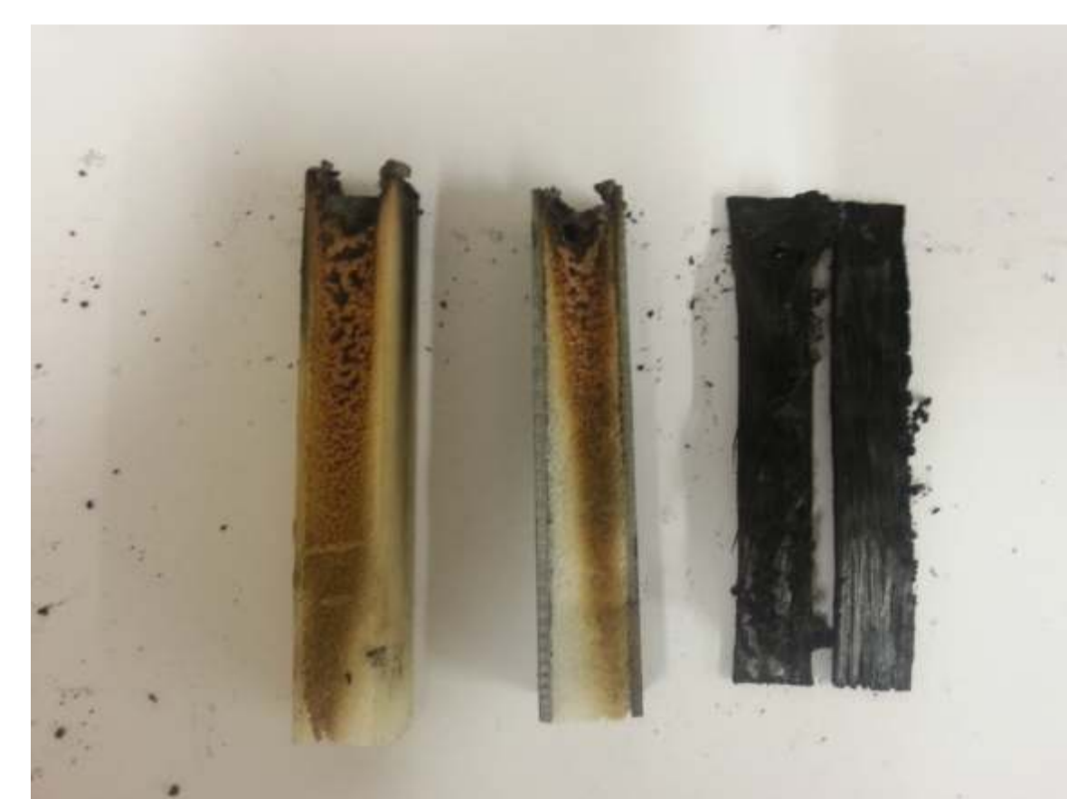
Rys. 4. Wygląd próbek kompozytów przekładkowych po badaniu odporności na płomień wg normy UL-94. Fig. 4. The sandwich composites after UL-94 test
