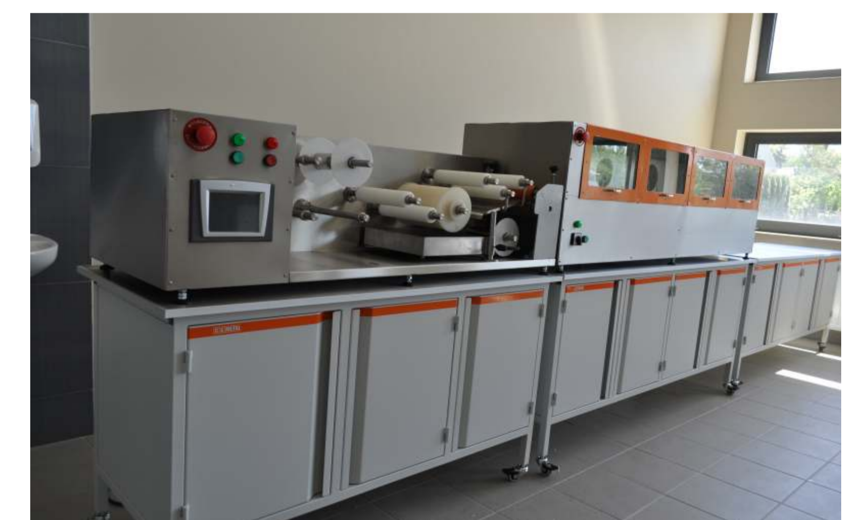
Rys. 9. Urządzenie laboratoryjne do wytwarzania maty kompozytowej „Prepreg” Fig. 9. The laboratory composite assembling line "Prepreg"
