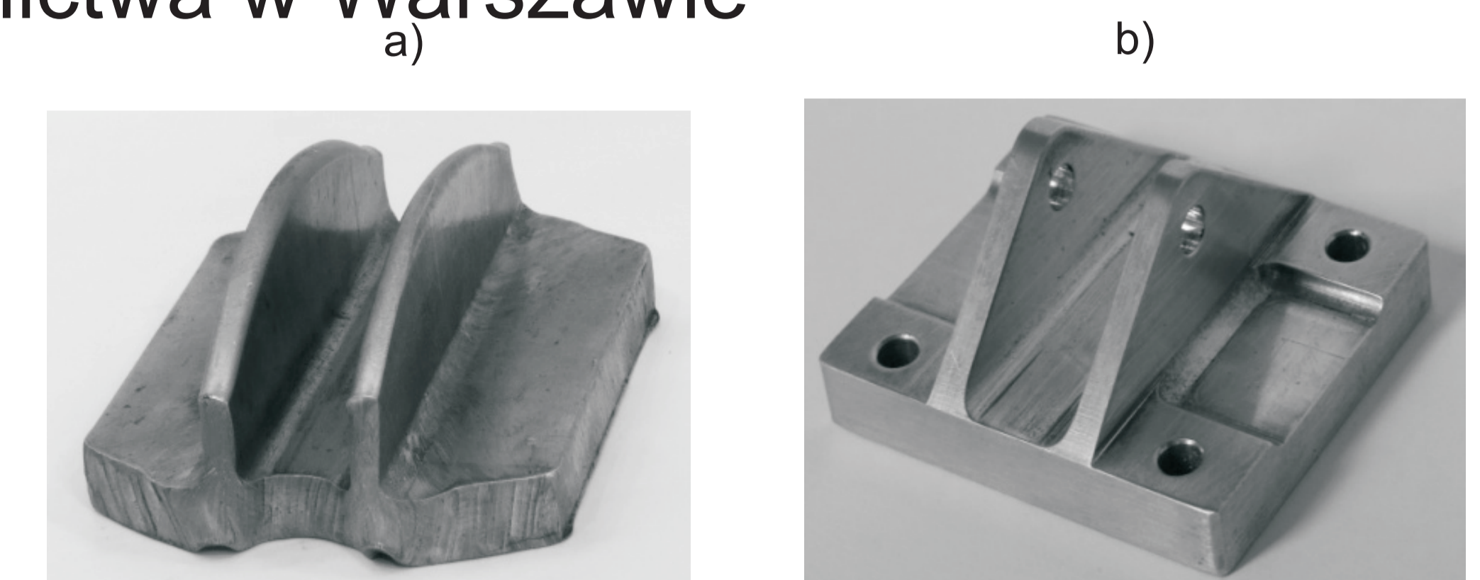
Rys. 11. Ukształtowana odłuki z dwoma żebrami ze stopu AZ31 w TPK (a) oraz wykonany z niej gotowy wspornik (b) Fig. 11. Flat forgings with two ribs from AZ31 alloy (a) obtained in the experimental tests and finished brackets made from them (b)
