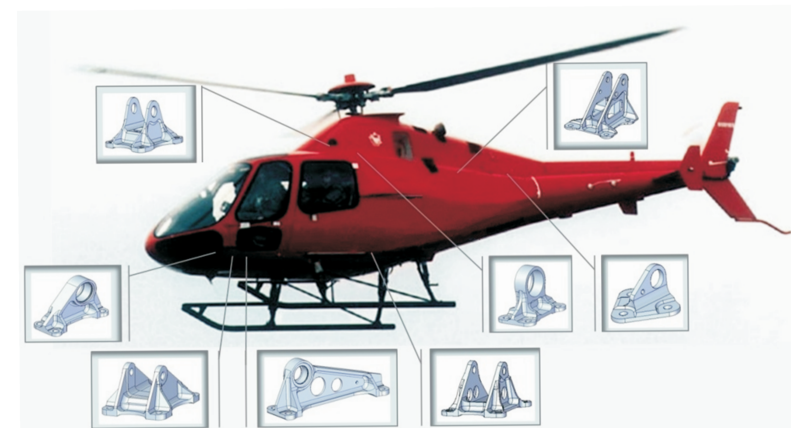
Rys. 12. Zastosowanie wyrobów uźebrowanych w przemyśle lotniczym Fig. 12. Application of flat parts with ribs in aircraft industry
