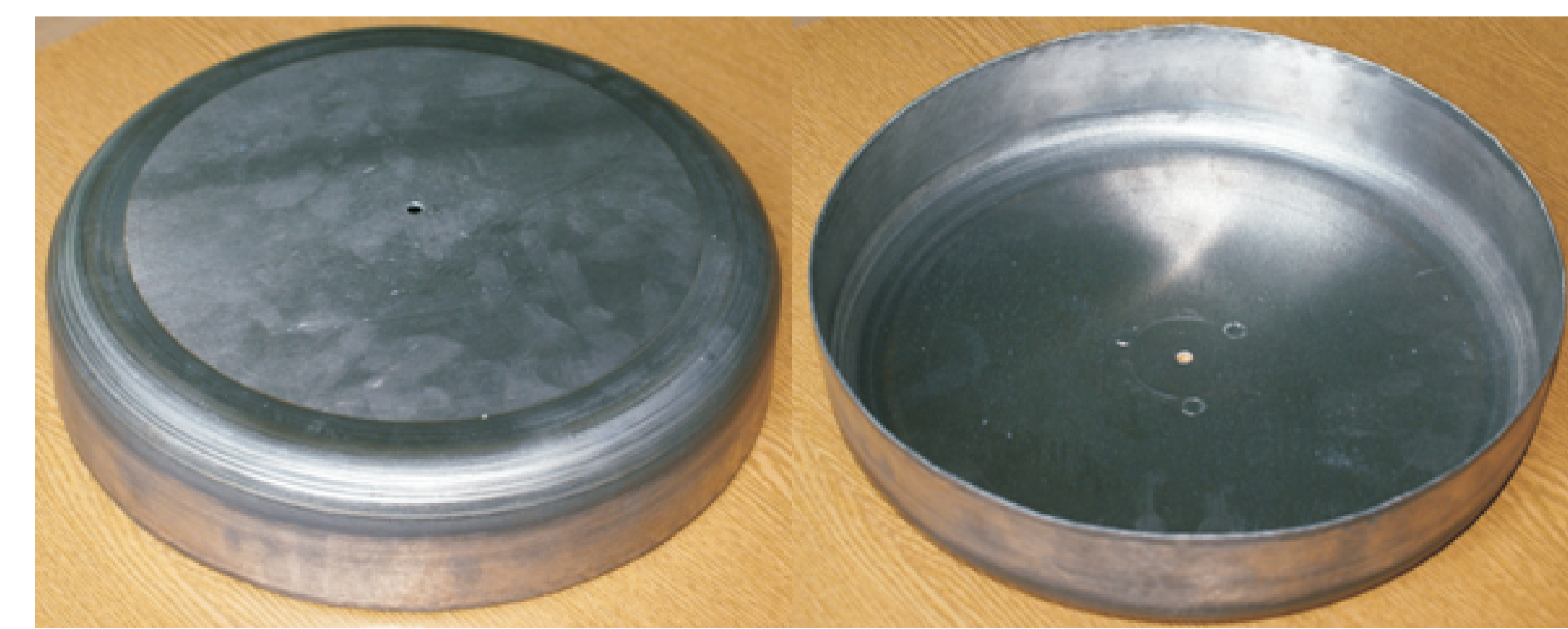
Przykładowe zastosowanie metody w przemyśle lotniczym - półwyrob pokrywy wirnika helikoptera po wyoblaniu (stop AZ31) Example of application in aviation - semi-finished product of the helicopter rotor hub cover after spinning (AZ31 alloy)
