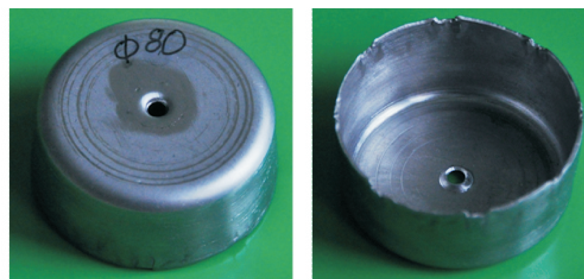
Wytłoczki otrzymane w wyniku wyoblania krążka o średnicy \phi 80 mm na wzorniku o średnicy \phi 42 mm (współczynnik wytlaczania m=0,525 , materiał stop aluminium 2024) Drawpieces made in the sheet metal spinning process (blank diameter \phi 80 mm, pattern diameter \phi 42 mm, deformation parameter m=0,525 , material: aluminum alloy 2024)
