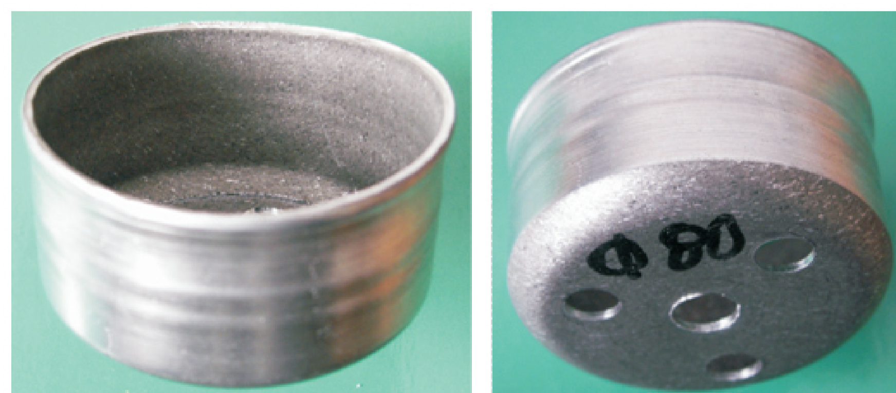
Wytłoczki otrzymane w wyniku wyoblania krążka o średnicy \phi 80 mm na wzorniku o średnicy \phi 42 mm (współczynnik wytlaczania m=0,525 , materiał stop magnezu AZ31) Drawpieces made in the sheet metal spinning process (blank diameter \phi 80 mm, pattern diameter \phi 42 mm, deformation parameter m=0,525 , material: magnesium alloy AZ31)
