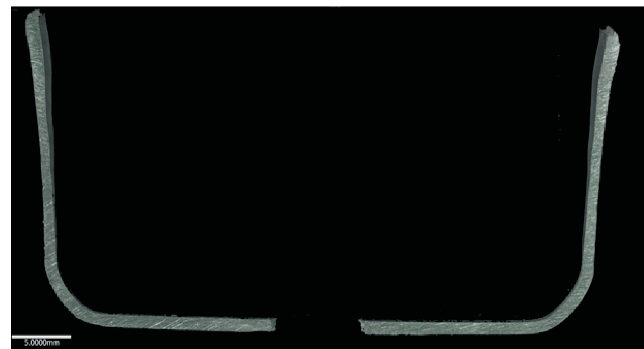
Przekrój poprzeczny wytłoczki ze stopu aluminium 2024 Cross-section of the aluminum alloy 2024 drawpiece
