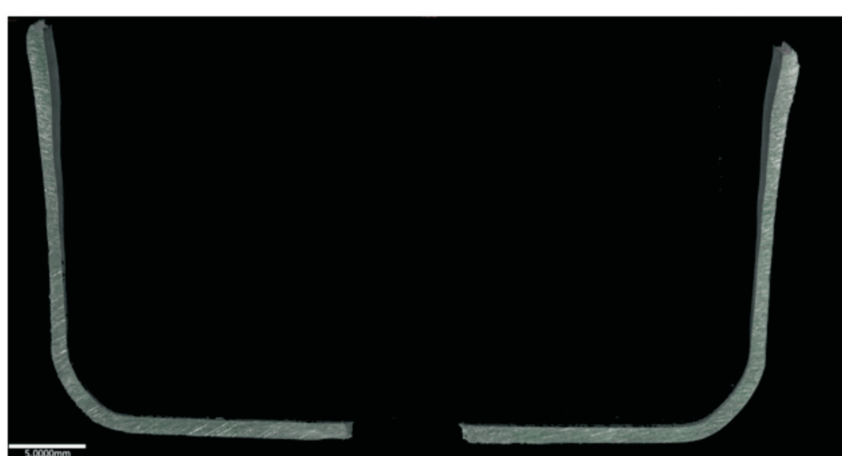
Przekrój poprzeczny wytłoczki ze stopu magnezu AZ31 Cross-section of the AZ31 drawpiece
