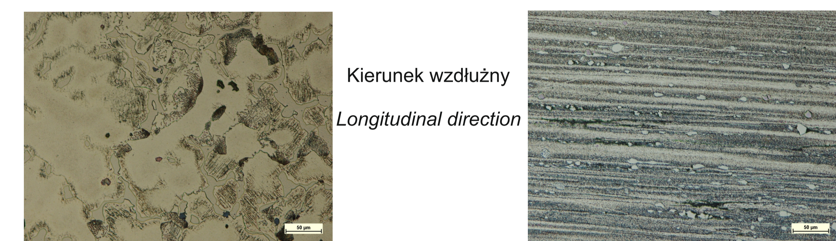
Rys. 8. Mikrostruktura stopu AZ91 a) materiału wyjściowego b) wiórów przemysłowych wyciśniętych metodą KOBO. Fig. 8. The microstructure of AZ91 alloy a) the initial material b) industrial chips extruded by KOBO method.
