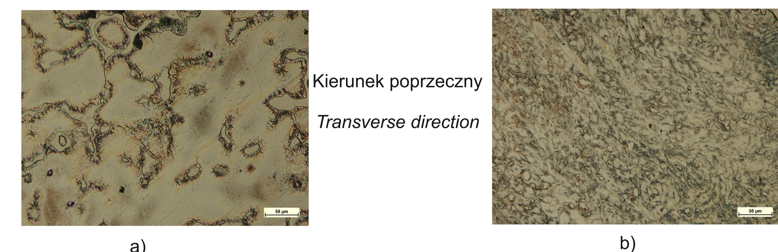
Rys. 7. Pręt ø6 mm z litego AZ91 (1) oraz konsolidowanych wiór przemysłowych z AZ91 (2). Fig. 7. Rod ø6 mm from solid AZ91 (1) and the consolidated industrial AZ91 chips (2).
