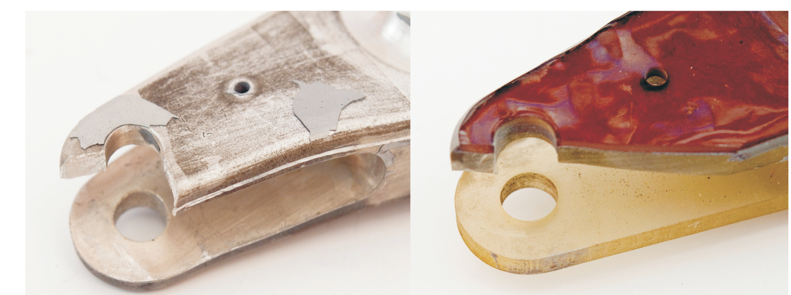
Rys.11. Obszar zniszczenia dźwigni w odkuwce ze stopu magnezu oraz modelu wykonanego techniką JS Fig.11. Destruction of the lever in the forging made from magnesium alloy and a model made with the JS technique
