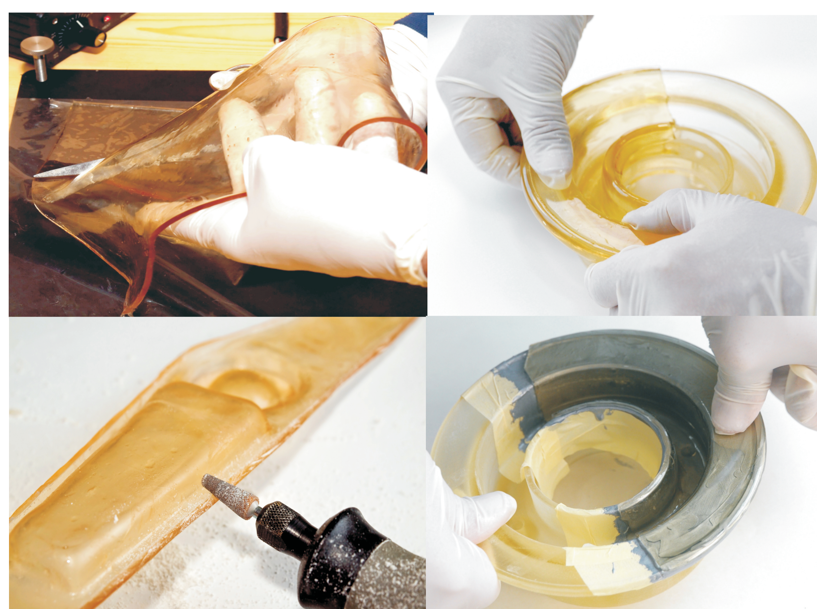
Rys.7. Wykonanie powłok elastoopiecznych na modelach piasty i dźwigni Fig.7. Applying photoelastic layers on hub and lever models
