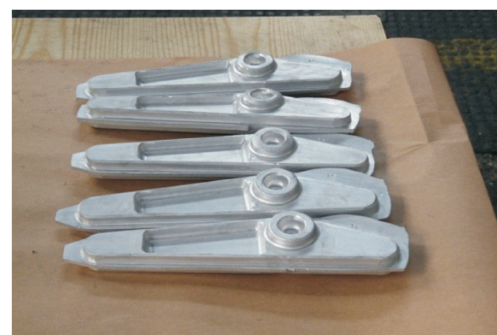
Rys.8. Widok odłuki matrycowej dźwigni. Fig.8. View of die forging of lever.
