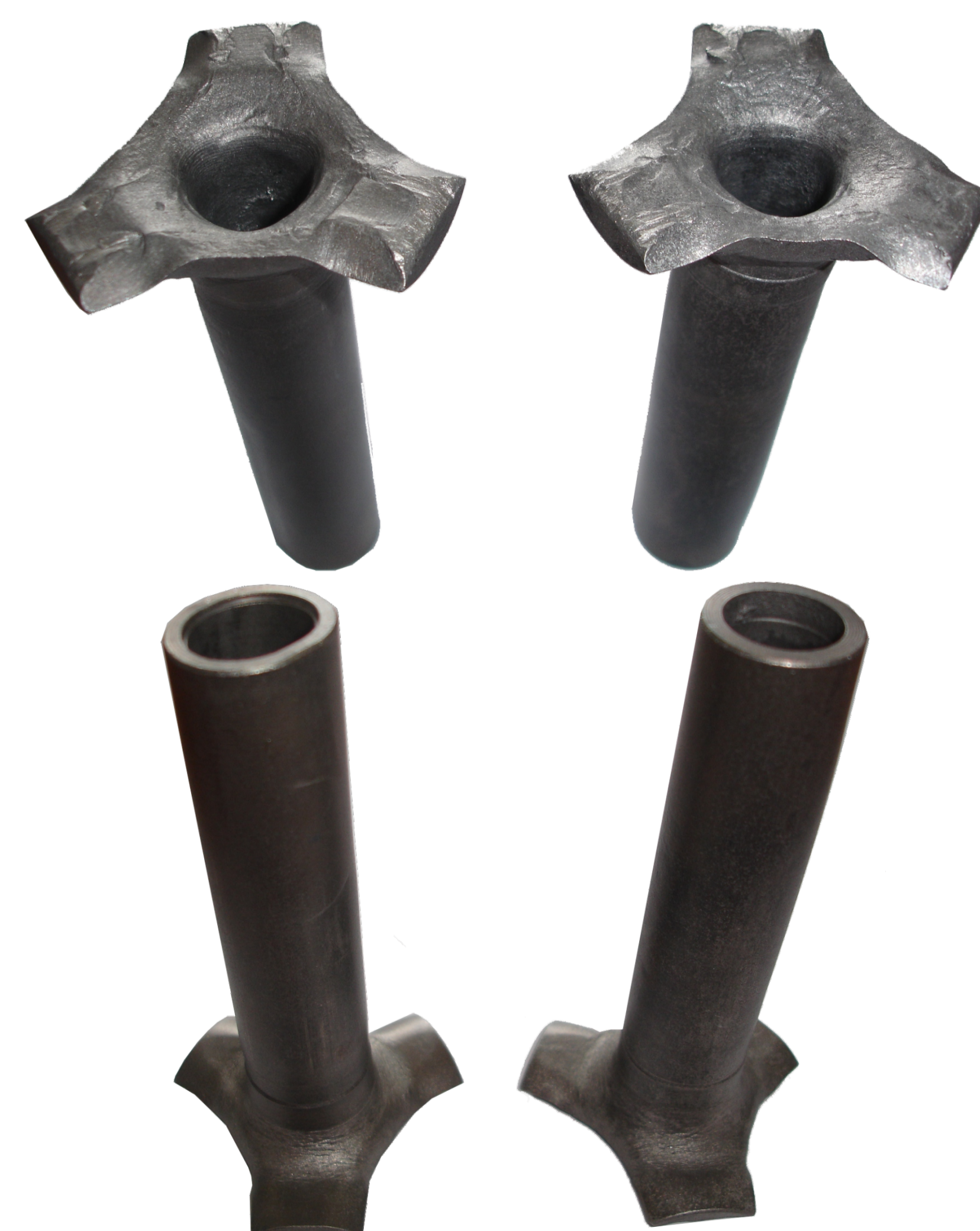
Rys. 6. Odkwki wału z kołnierzem wykonanego ze stopu tytanu Ti6Al4V. Fig. 6. Forging of hollow shaft from Ti6Al4V titanium alloy.
