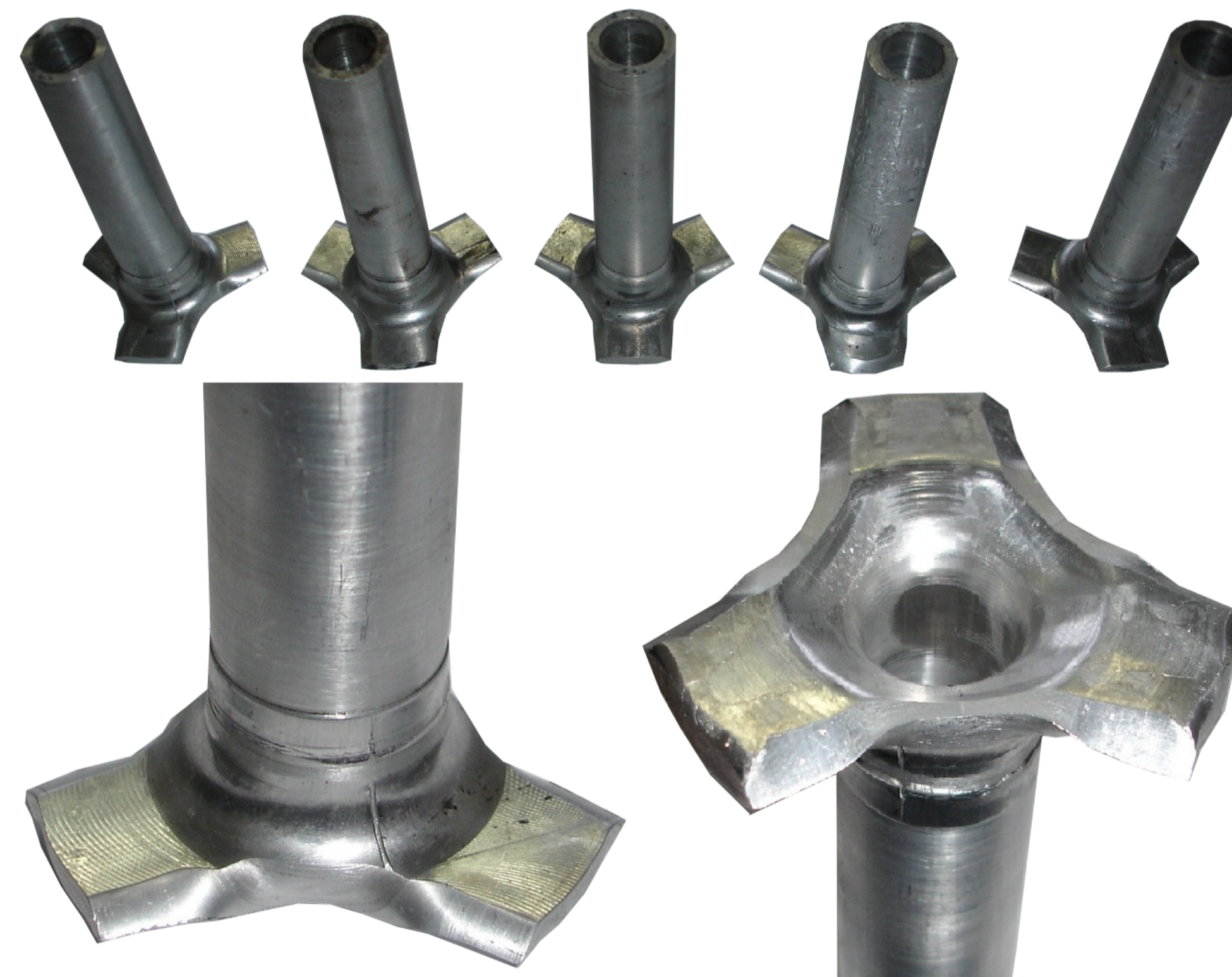
Rys. 5. Odkwki wału z kołnierzem wykonanego ze stopu aluminium 2618. Fig. 5. Forging of hollow shaft from 2618 aluminum alloy.
