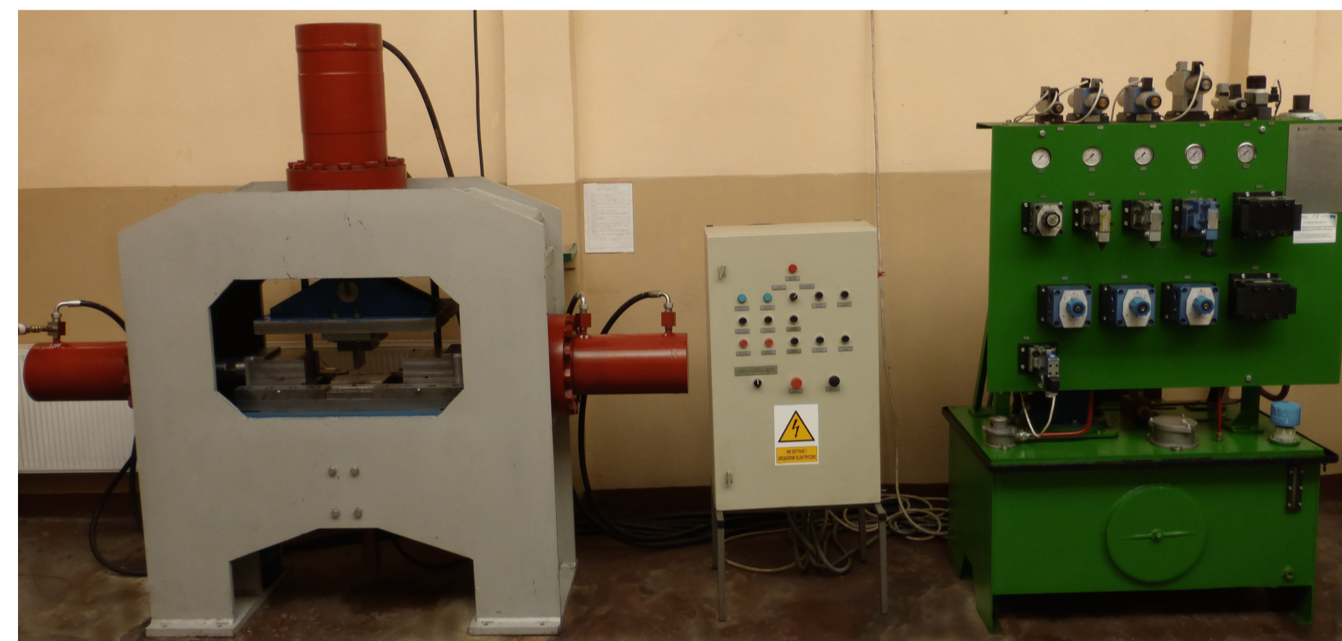
Rys. 4. Trójsuwakowa prasa kuznicza. Fig. 4. Three-slide forging press.
