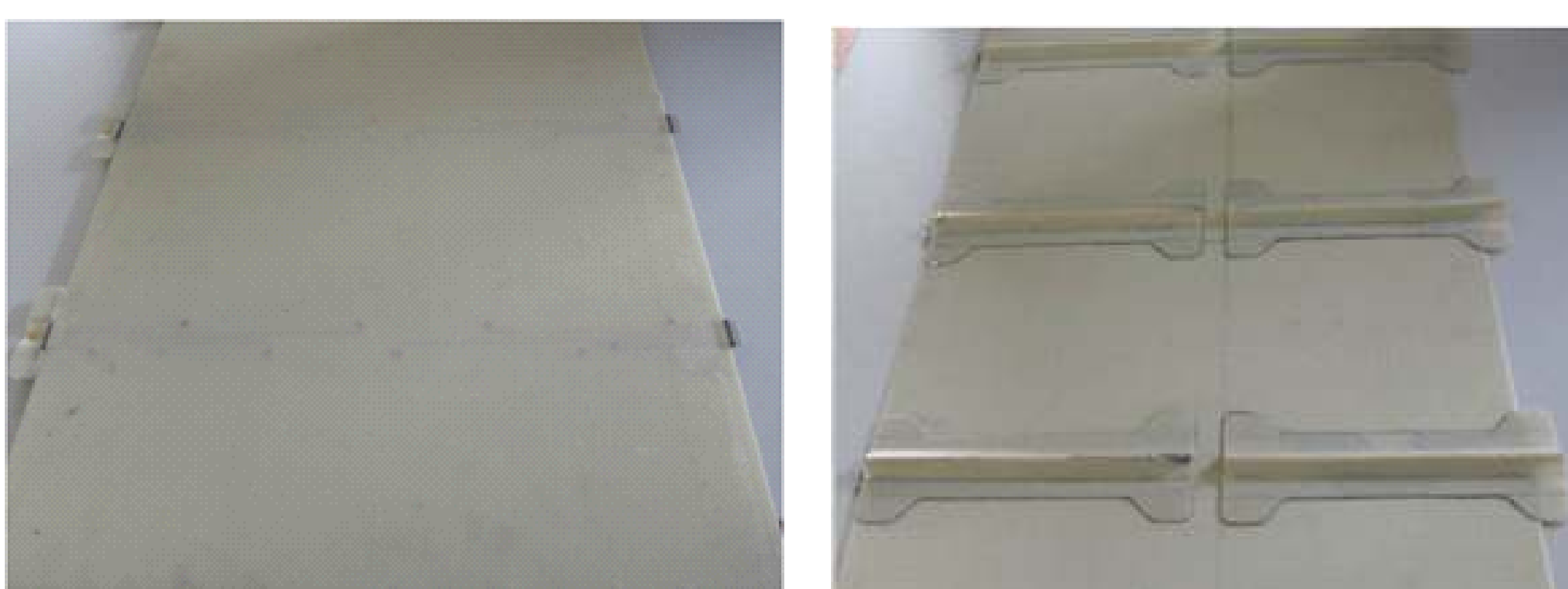
Rys. 12. Ramowy schemat „inteligentnej” struktury kompozytywnej w konfiguracji mogącej służyć m.in. do detekcji odklejeń elementów strukturalnych Fig. 12. Scheme of smart composite structure in the setup configured towards detection of structural elements debondings
