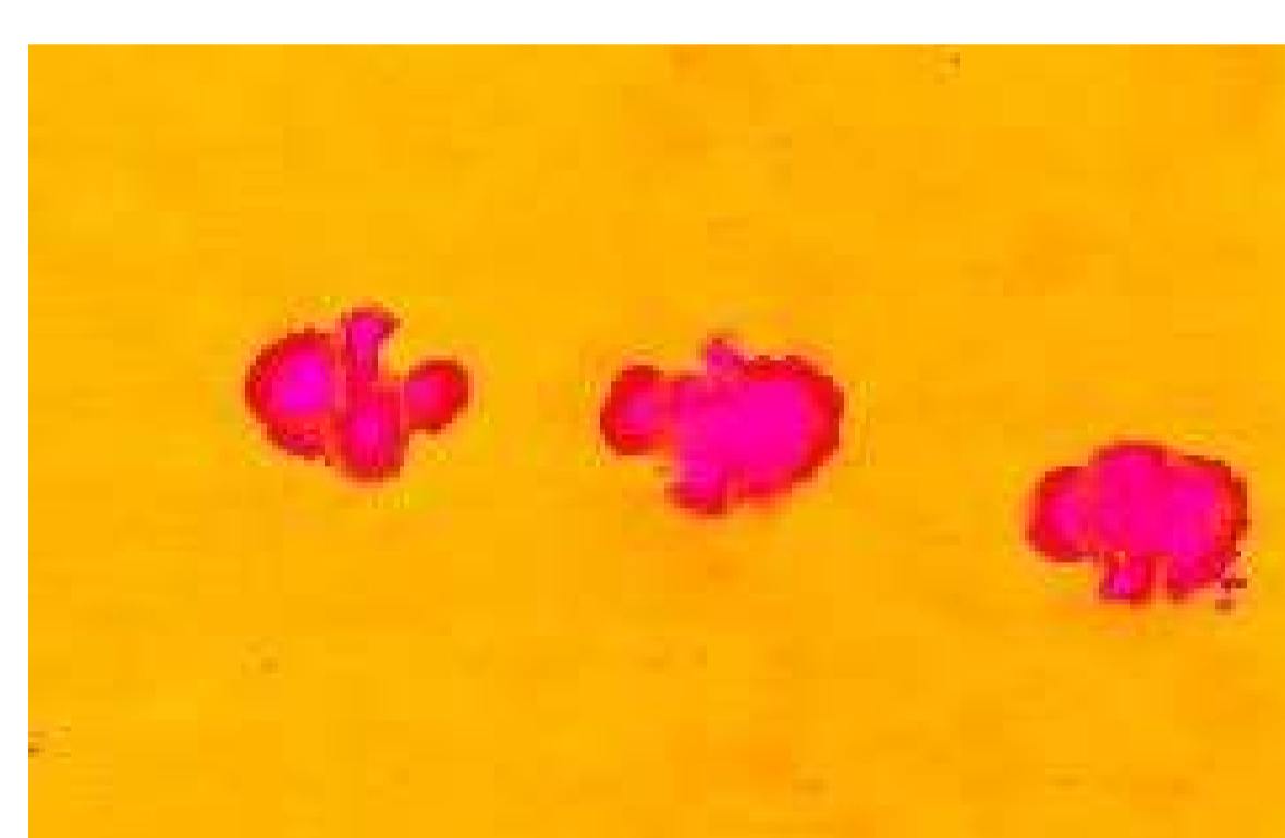
Rys. 7. Wyniki badań próbki CFRP metod ultradźwięków Fig. 7. Results of ultrasonography test of CFRP specimen
