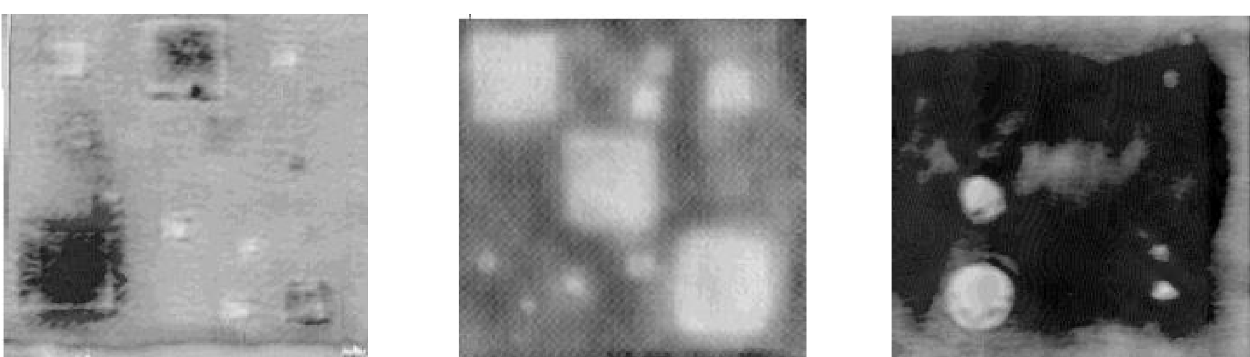
Rys. 3. Wyniki badań próbek wzorcowych FML metod ultradźwięków - głowica jednoprzetwornikowa Fig. 3. Results of ultrasonography test of reference FML specimens - single sensor transducer
