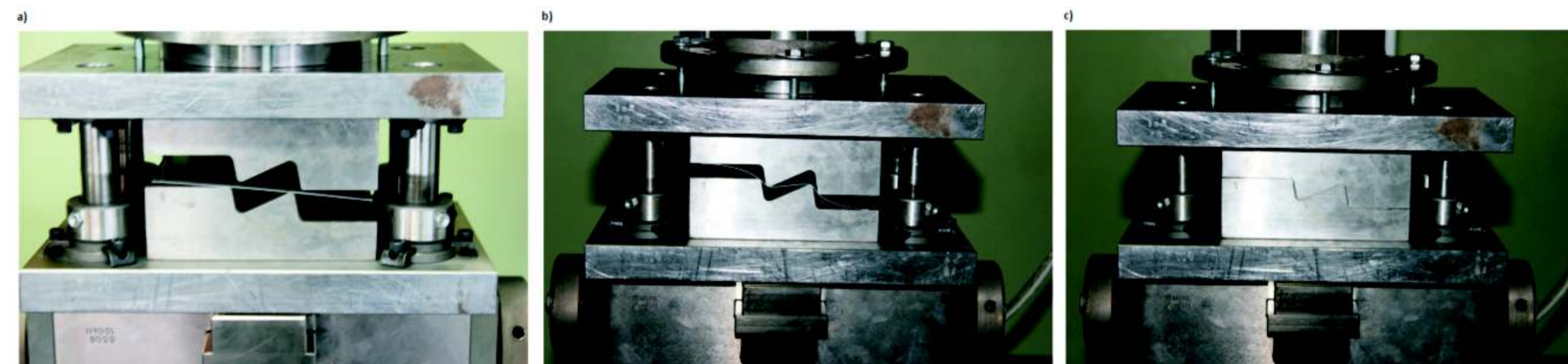
Rys.3. Etapy formowania blach w matrycy Fig.3. Stages of sheet metal forming in the die
