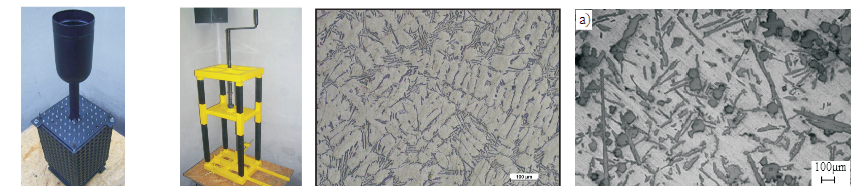
Rys. 10. Rdzennica dla łączników prostych i prasa do wytwarzania rdzeni Figs. 10. Core-box for simple connectors and press for core preparation Rys. 11. Mikrostruktura odlewu szkieletowego – stop AISI11 Fig. 11. Skeleton casting microstructure – AISI11 alloy Rys. 12. Mikrostruktura odlewu szkieletowego – kompozyt AISI11 + węgiel Fig. 12. Skeleton casting microstructure – AISI11 + carbides composite
