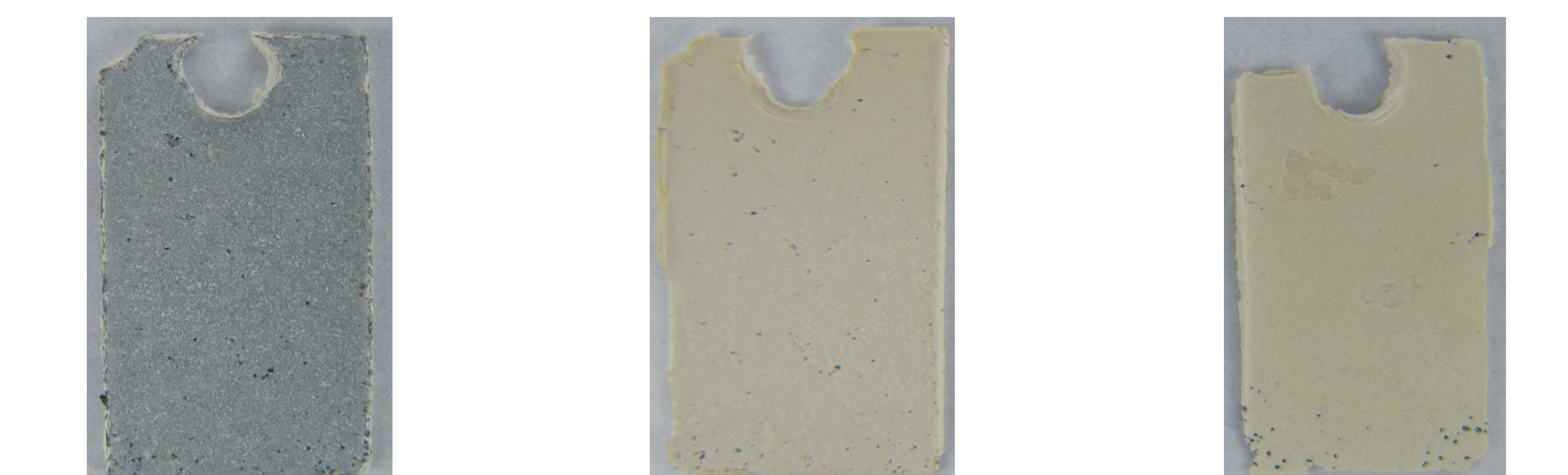
Wygląd próbki ze stopu C-103 z warstwą aluminium wytworzoną metodą proszkową wraz z odpadniętą zgorzeliną, po 2 godz. utleniania przy temperaturze 1100°C, w tlenie Samples appearance of C-103 alloy with aluminum coating produced by pack cementation method with scale fall off after 2 hours oxidation at a temperature of 1100°C in oxygen
