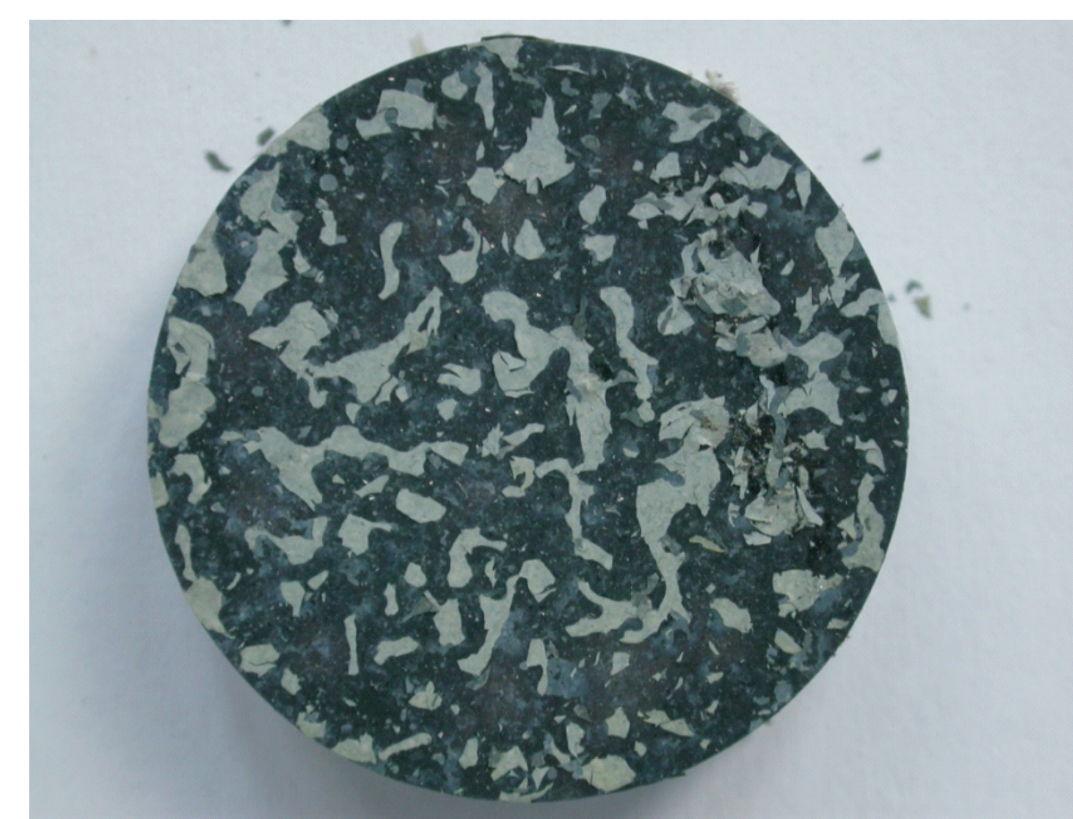
Powierzchnia stopu tytanu Timetal 1100 po badaniach utleniania w temperaturze 800C w atmosferze powietrza + 1 % H2O + 1 % SO2 Surface of the Timetal 1100 titanium alloy after the oxidation test conducted at 800°C in an air atmosphere + 1 % H2O + 1 % SO2
