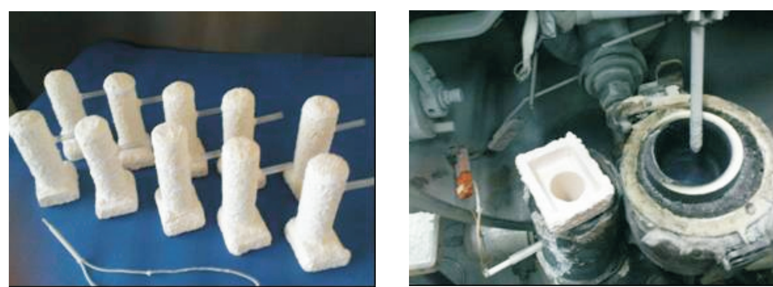
Formy ceramiczne oraz widok komory pieca indukcyjnego Baltzers
