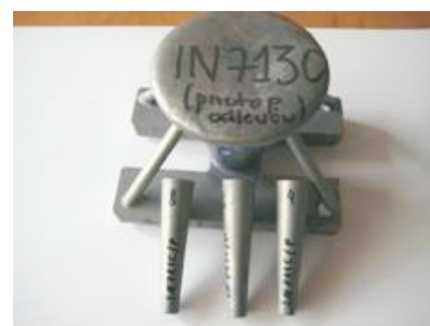
Przykład gotowego odlewu ze stopu IN-713C.
