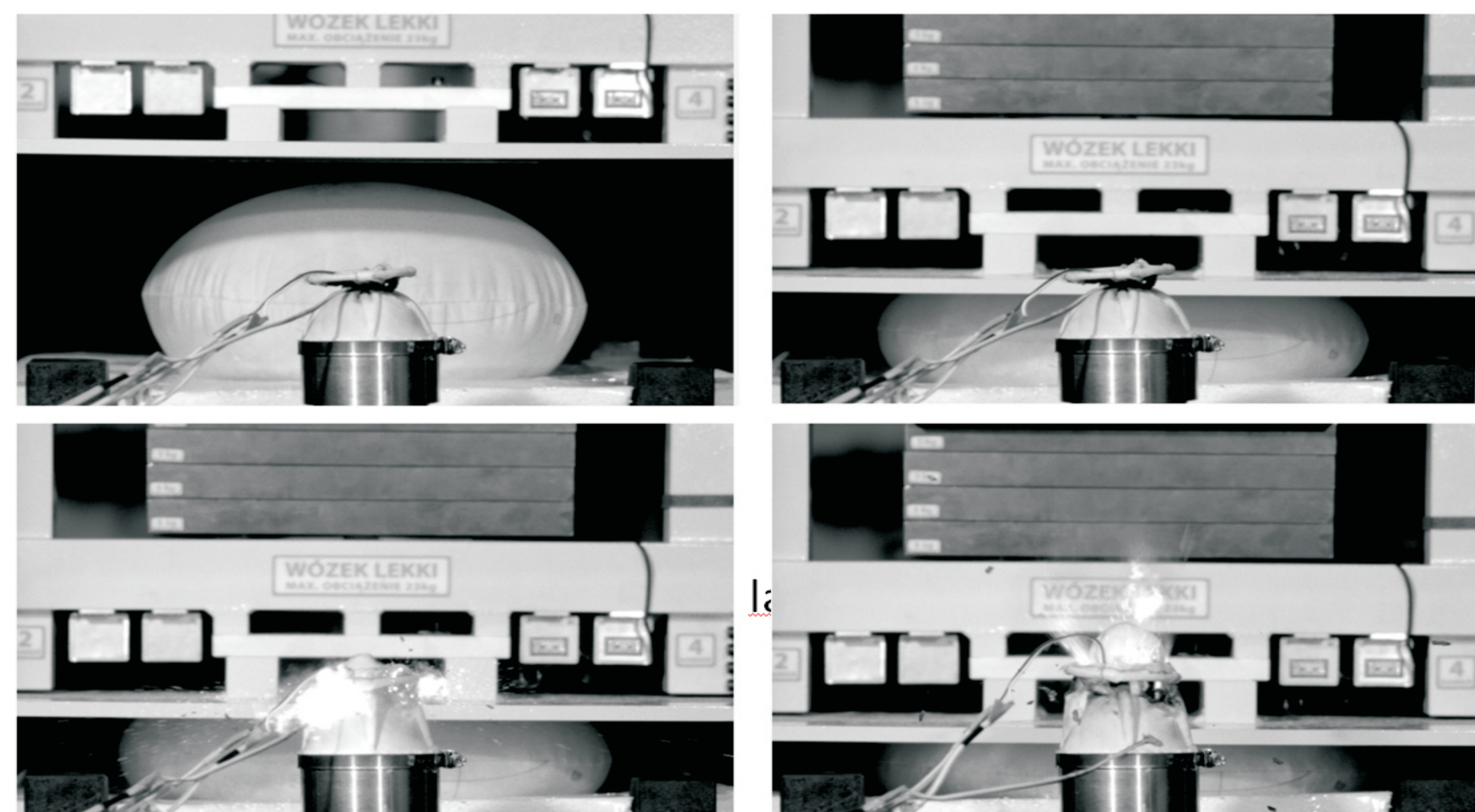
Rys. 7 Widok sekwencji działania demonstratora poduszki adaptacyjnej. Fig. 7 View of the HPV demonstrator model operation sequence.
