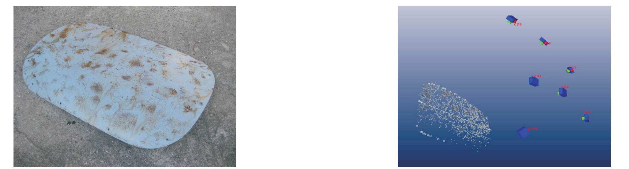
Rys. 13: Pomalowana powłoka z kompozytu lotniczego na betonowej płycie w trakcie sesji fotogrametrycznej. Fig. 13: Painted shell of made of aviation composite placed on a concrete slab during photogrammetric session.
