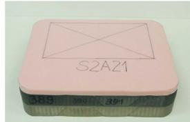
Rys. 1. Półprzekrój próbki wkładu siedziska 2-warstwowego składającego się z górnej warstwy pianki V5030 o grubości 50 mm i dolnej warstwy złożonej z 12 auksetycznych kształtek S364MDA o grubości 50 mm i współczynnikiem kompresji Rcv ~ 2
