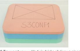
Rys. 7. Wkład siedziska z wiskoelastycznej pianki V5030 o wysokości 125 mm
