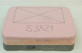
Rys. 3. Półprzekrój próbki wkładu siedziska 3-warstwowego składającego się z górnej warstwy pianki V5030 o grubości 25 mm, środkowej warstwy złożonej z 12 auksetycznych kształtek V5030A o grubości 50 mm i współczynnikiem kompresji Rcv ~ 1,8 i dolnej warstwy złożonej z 12 auksetycznych kształtek V5030A o grubości 50 mm i współczynnikiem kompresji Rcv ~ 2
