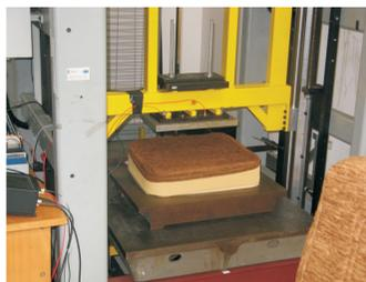
Rys. 11. Zrzut bijką o powierzchni 203x356 mm i masie 77,5 kg; próbki wkładów siedzisk w pokrowcu i bez pokrowca
