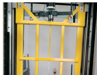
Rys. 13. Zrzut próbki siedziska z wciśniętym włgłbnikiem typu RCLI o masie 77,5 kg; próbki wkładów siedzisk w pokrowcu i bez pokrowca
