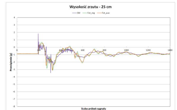
Rys. 17. Zależność przeciążenia pionowego (Nz) od czasu w próbie zrzutu śmigłowca z wysokości 25 cm
