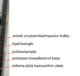
Rys. 10. Stanowisko do badań zrzutowych w Adaptronica Sp. z o.o.
