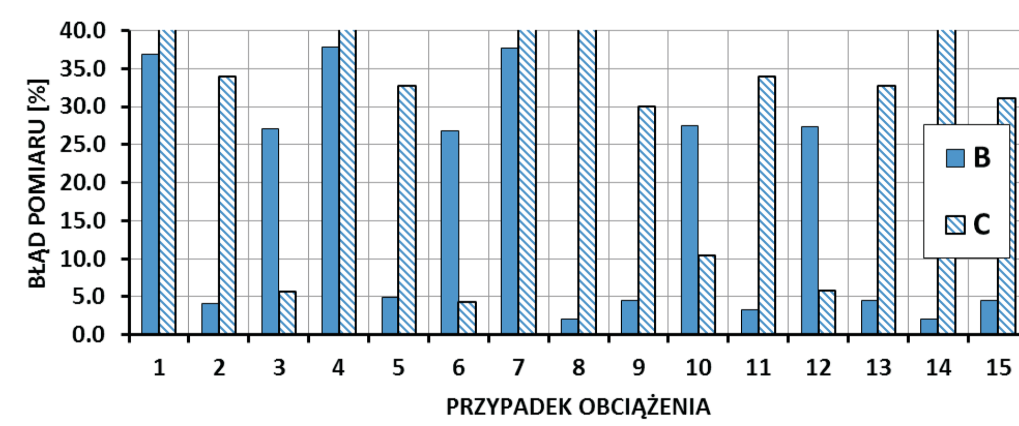
Rys.11 Błąd pomiaru siły tnącej - przekrój OPT Fig.11 Shear force measurement errors - section OPT
