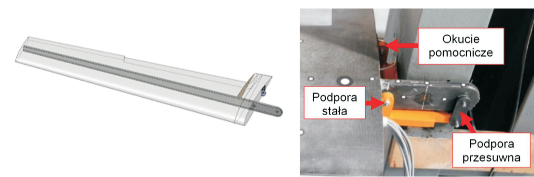
Rys.2 Geometria CAD badanego skrzydła oraz szczegóły zamocowania Fig.2 CAD geometry of tested wing and details of attachments
