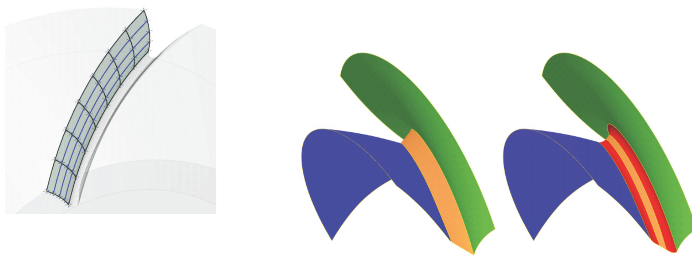
Rys. 3 Powierzchnia otrzymana na podstawie profili oraz tworzenie powierzchni ciągłej Fig. 3 Surface obtained by profiles using (left) and generating of continuous surface
