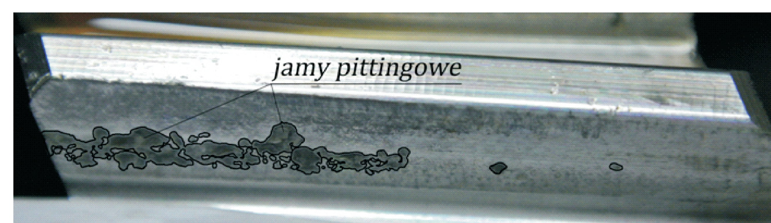
Rys. 5. Pitting na kole badanej przekładni ewolwentowej po piątym stopniu obciążenia Fig. 5. Involute gear pitting over fifth load stage
