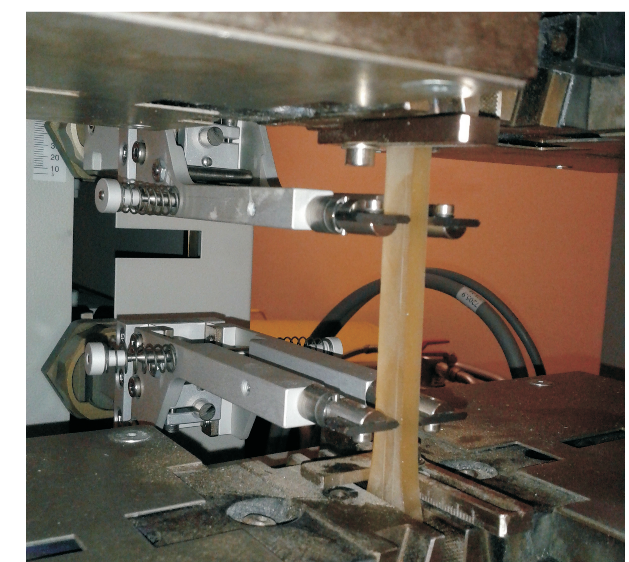
Rys.4. Wyznaczanie modułu Younga Fig.4. Determination of the Young's modulus
