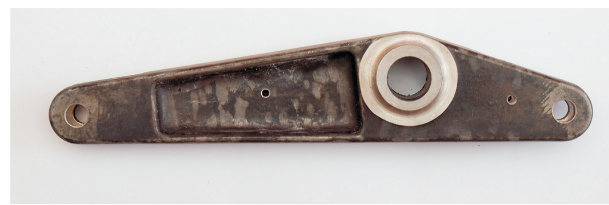
Rys. 2. Odkuwka ze stopu Mg dźwigni - po obróbce mechanicznej Fig. 2. Forged Mg alloy lever - after machining
