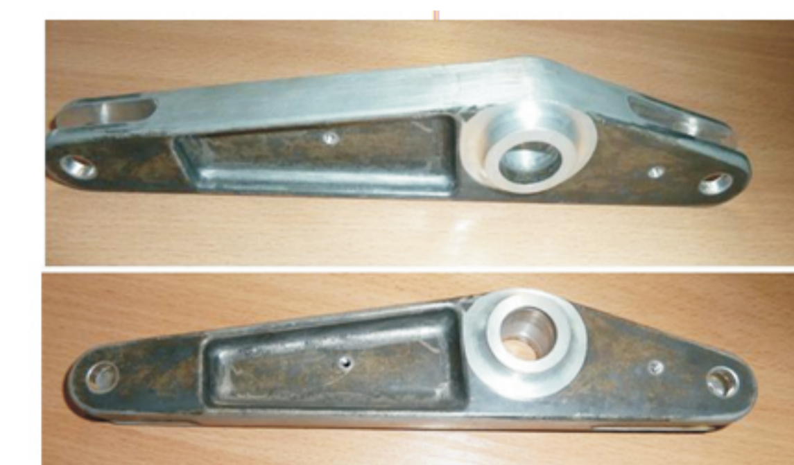
Rys. 2. Dźwignia układu sterowania śmigłowca ILX-27 wykonana ze stopu AZ31 (odkuwka obrabiana mechanicznie).
