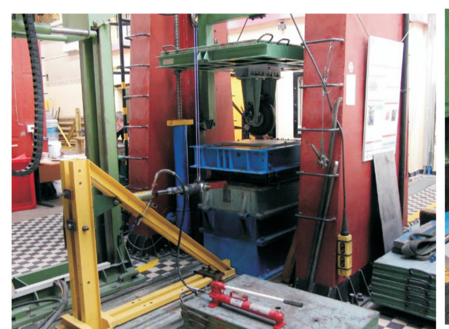
Rys. 2. Konfiguracja stanowiska Mlot 10T do zadawania sił złożonych.
