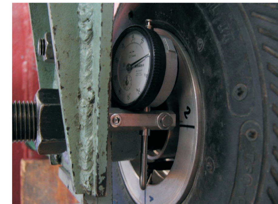
Rys. 1. Sposób pomiaru odkształcenia piasty podczas prób obciążenia promieniowego.
