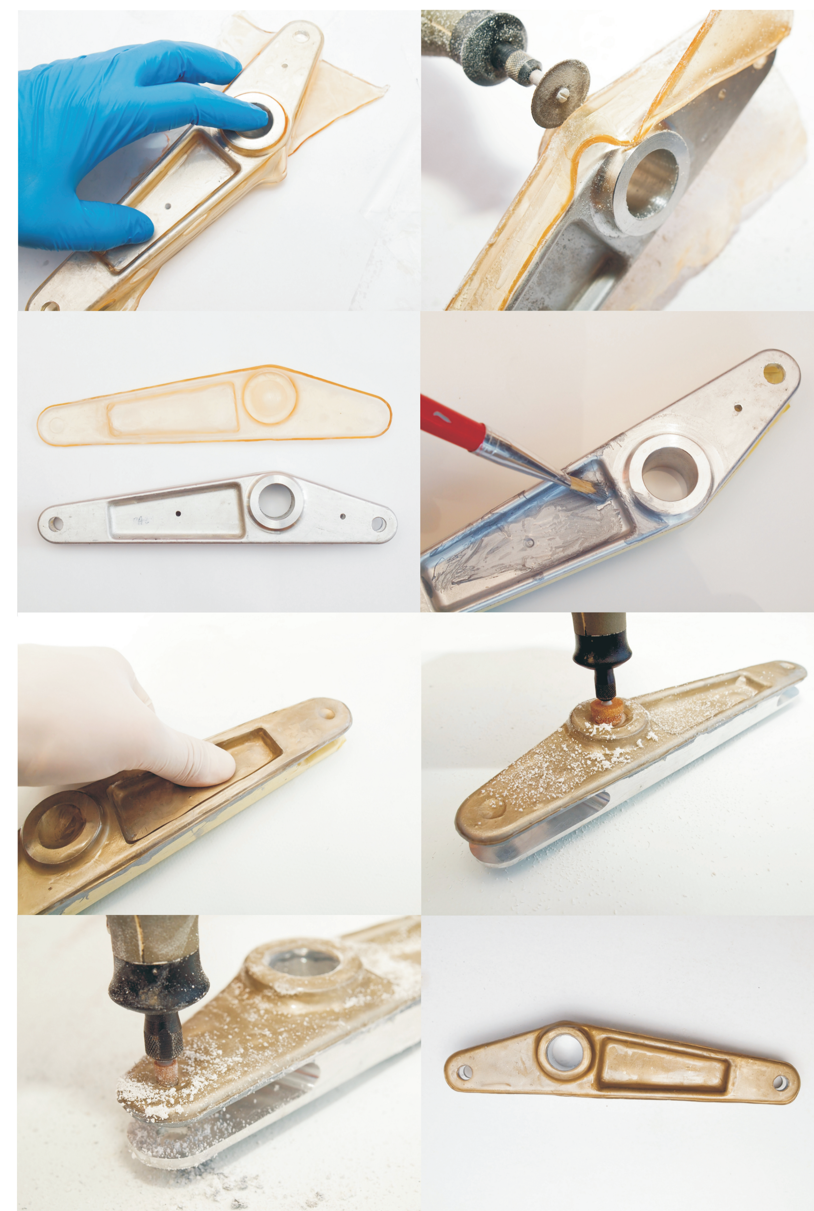
Rys.3. Proces wykonania powłoki optycznie czynnej na badanej dźwigni ze stopu aluminium Fig.3. The process for an optically active coating on the test aluminium alloy lever
