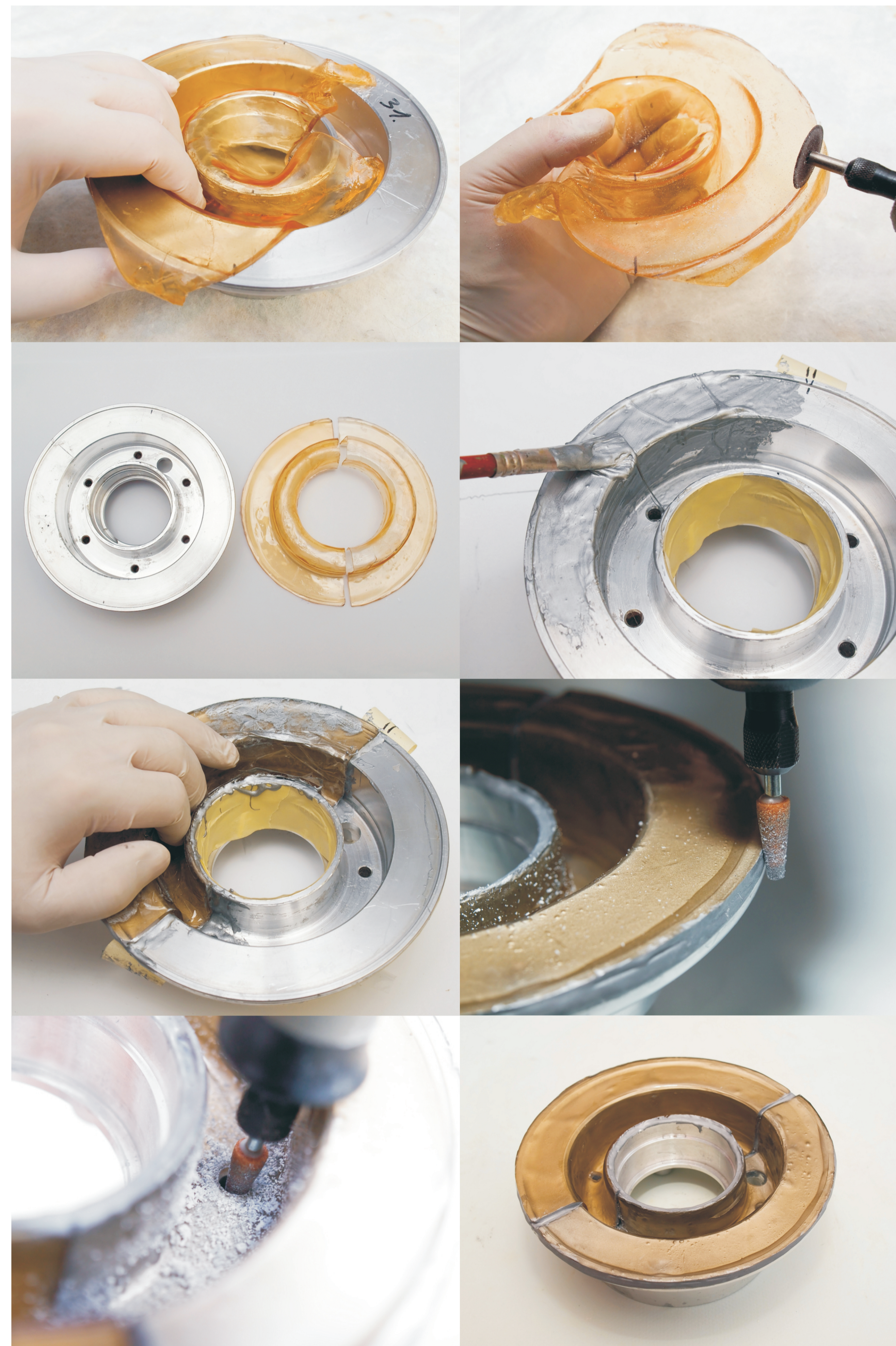
Rys.3. Proces wykonania powłoki optycznie czynnej na badanej piście koła samolotu ze stopu aluminium Fig.3. The process for an optically active coating on the test aluminium alloy of aircraft wheel hub
