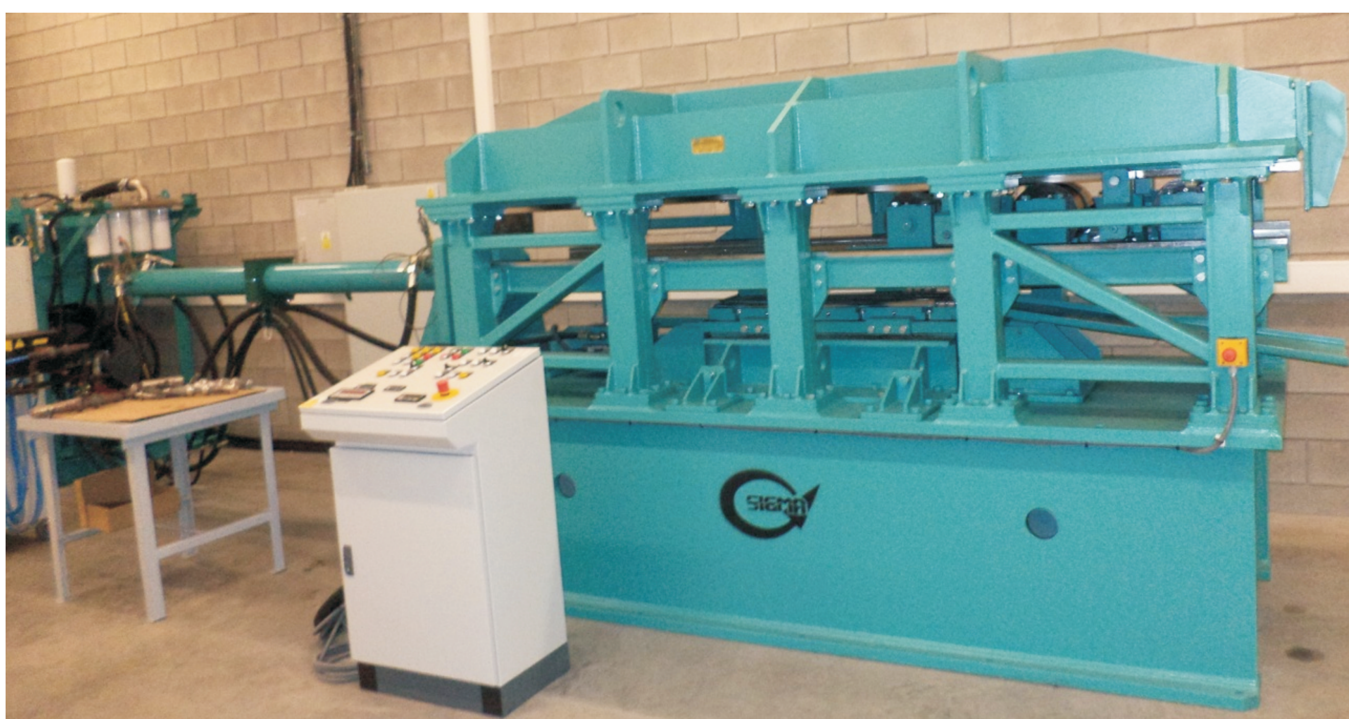
Rys. 3. Walcarka płaskoklinowa wykorzystana w badaniach doświadczalnych Fig. 3. Flat wedge rolling mill used in the experimental trials
