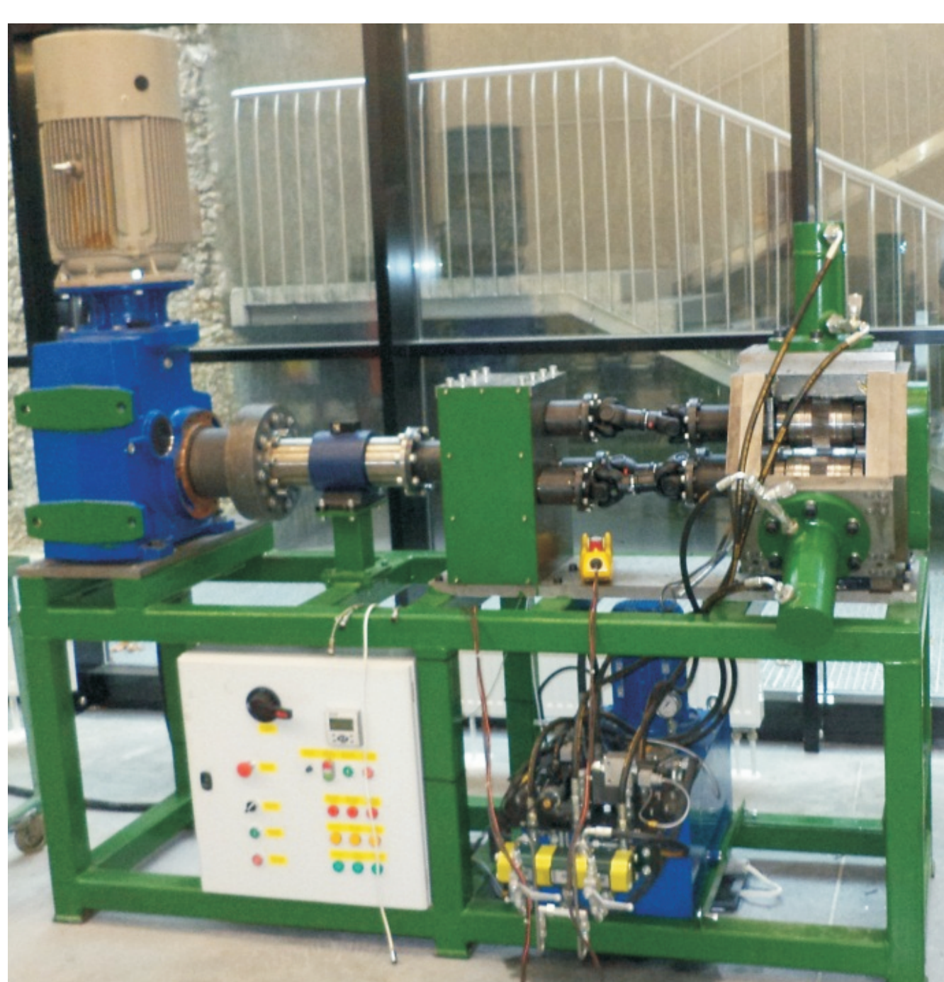
Rys. 5. Agregat kuzniczy do obciskania obrotowego Fig. 5. A forging device for rotary compression
