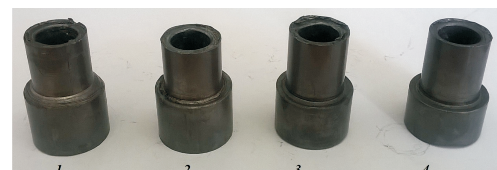
Rys. 11. Tuleje z kołnierzami uzyskane podczas badań doświadczalnych Fig. 11. Flanged sleeves obtained during experimental trials
