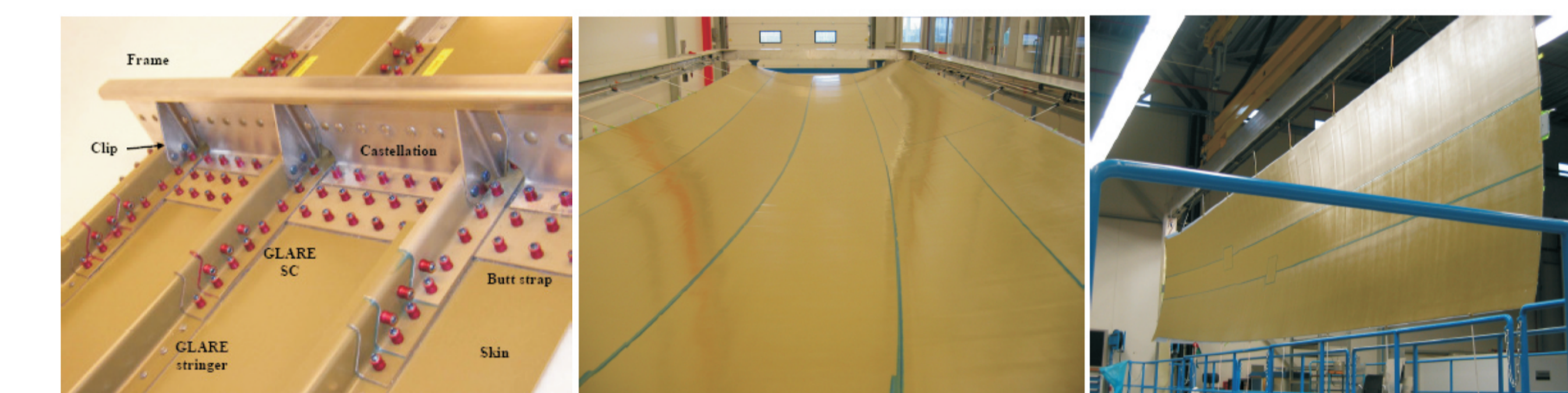
Rys. 7. Laminaty FML w strukturach lotniczych (J. Sinke 2006) Fig. 7. FML laminates in aircraft structures (J. Sinke 2006)
