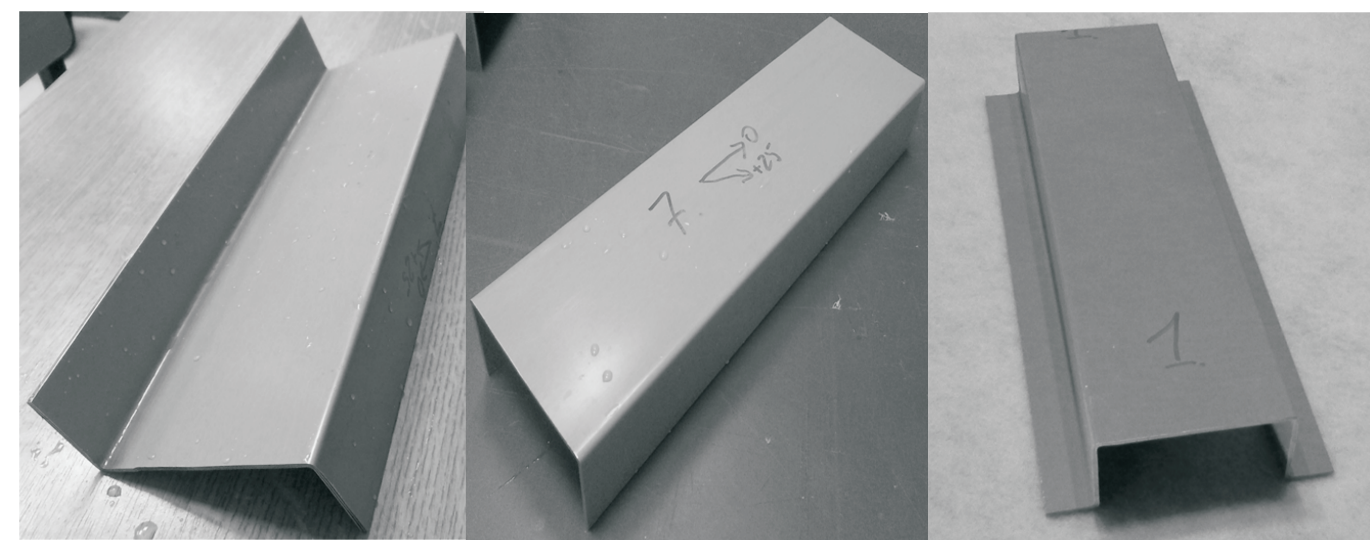
Rys. 4. Profile kształtowe wykonane z laminatu FML Fig. 4. Spatial profiles made from FML laminate
