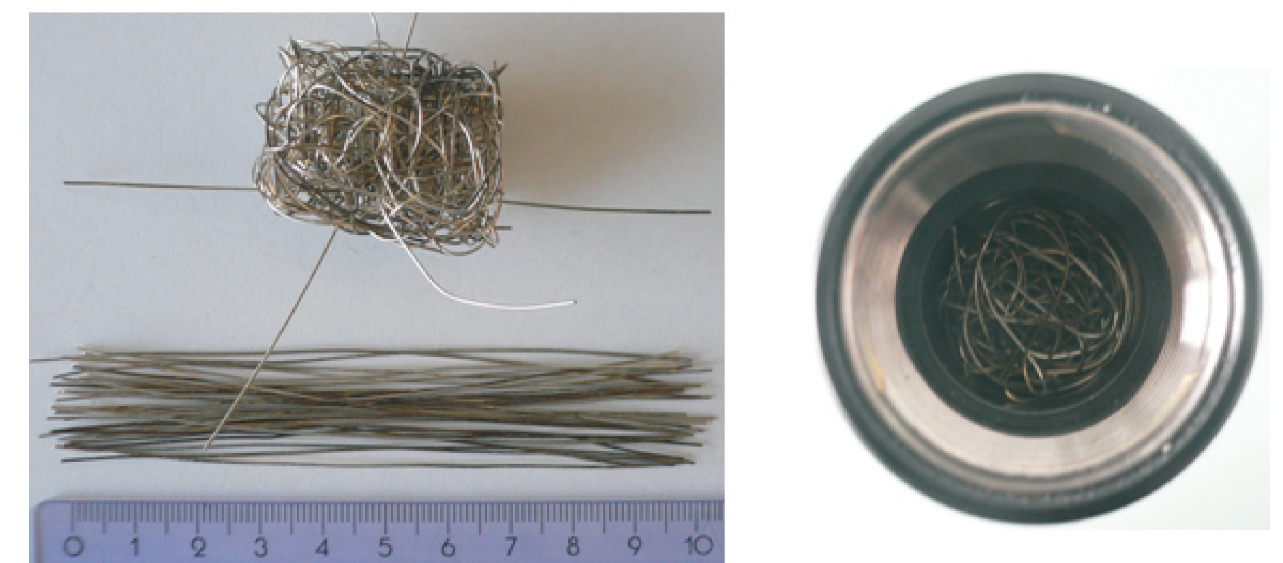
Rys. 1: Sposób ręcznego wykonywania próbek włóknistych z posrebrzanego miedzianego drutu o średnicy 0,5mm, przy pomocy pomiarowej rury impedancyjnej (widoczna próbka w rurze). Fig. 1: The method of manufacturing of fibrous samples from a copper wire with diameter 0.5mm, using the tube from the acoustic measurement kit (see a sample in the tube)
