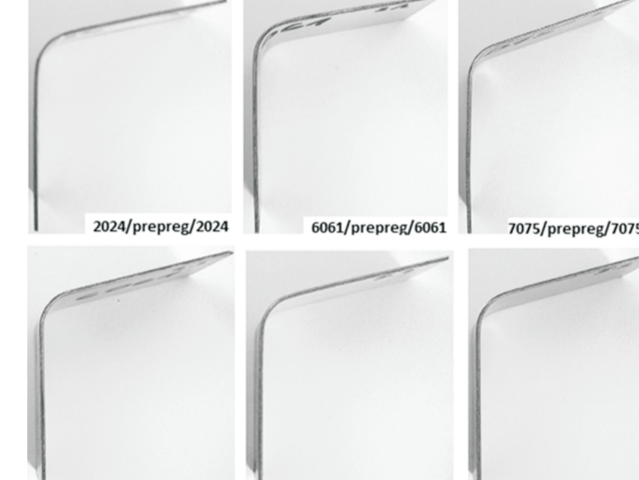
Rys. 10. Zdjęcia giętych kompozytów typu GLARE Fig. 10. Pictures of bent GLARE type composites
