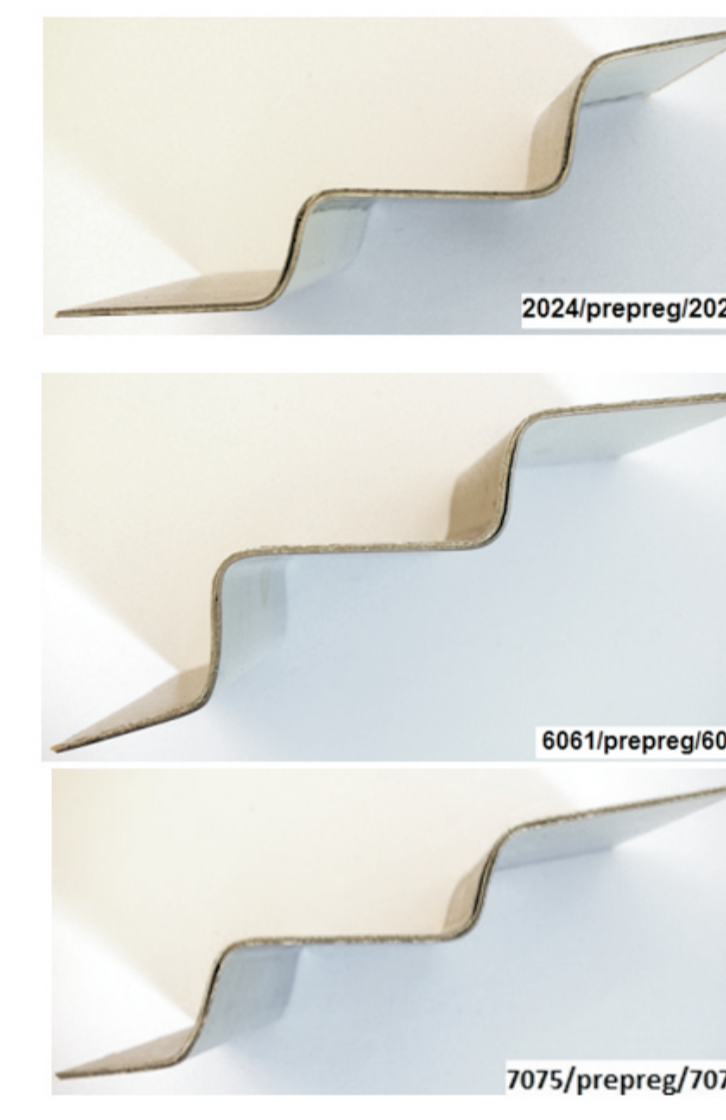
Rys. 7. Zdjęcia kompozytów typu GLARE po procesie formowania w matrycy Fig. 7. Pictures of GLARE type composites after forming process in the matrix
