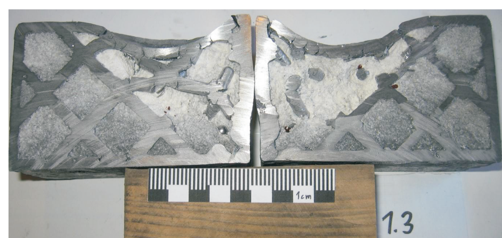
Rys. 15. Odlewy szkieletowe z wypełnieniem po testach zderzeniowych Fig. 15. Filled skeleton castings after impact tests
