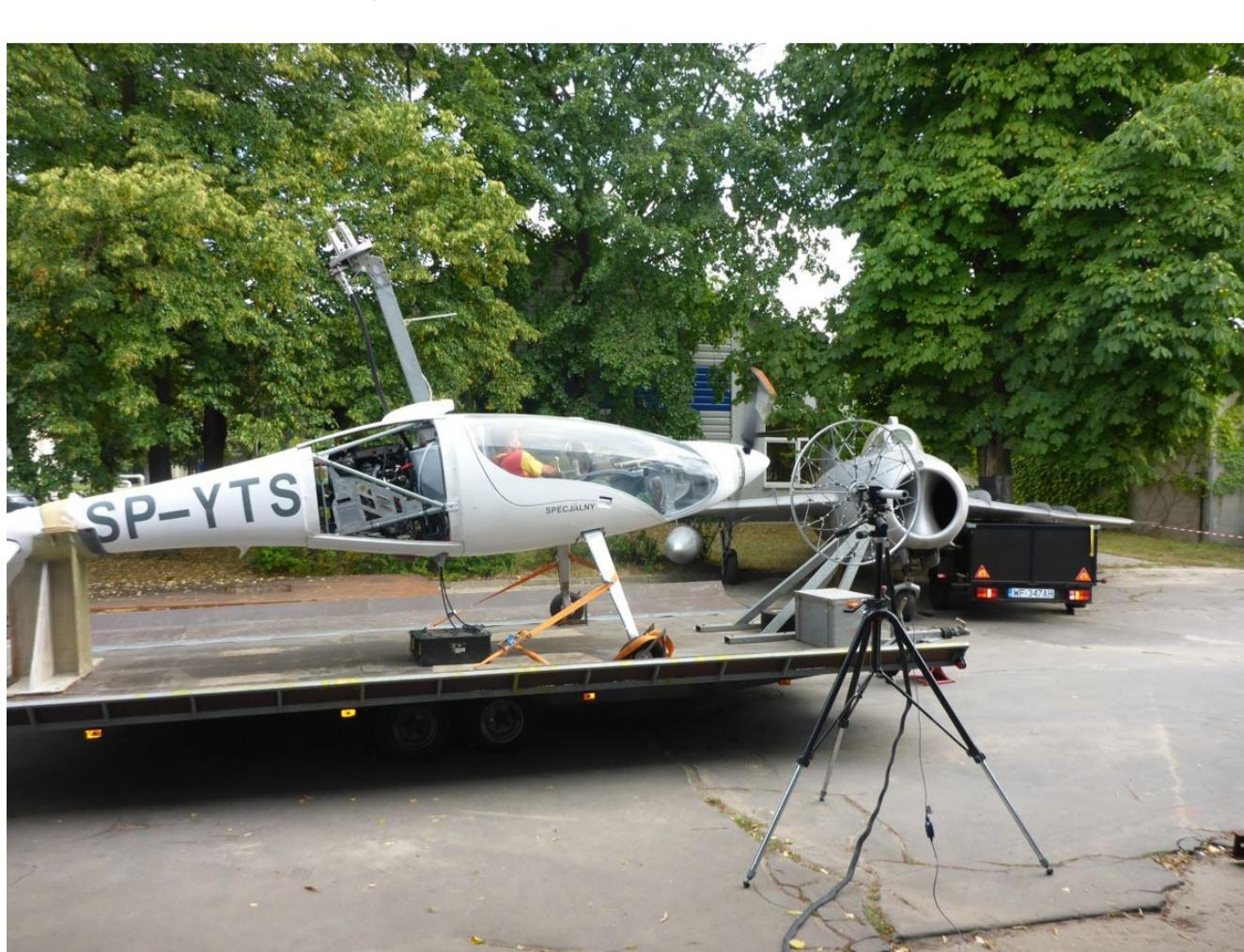
Rys. 7. Pomiar akustyczne wiatrakowca - beamforming, 6 metrów od mierzonego obiektu. Po lewej zdjęcie wiatrakowca, po prawej rozkład natężenia źródeł dźwięku w płaszczyźnie wiatrakowca
