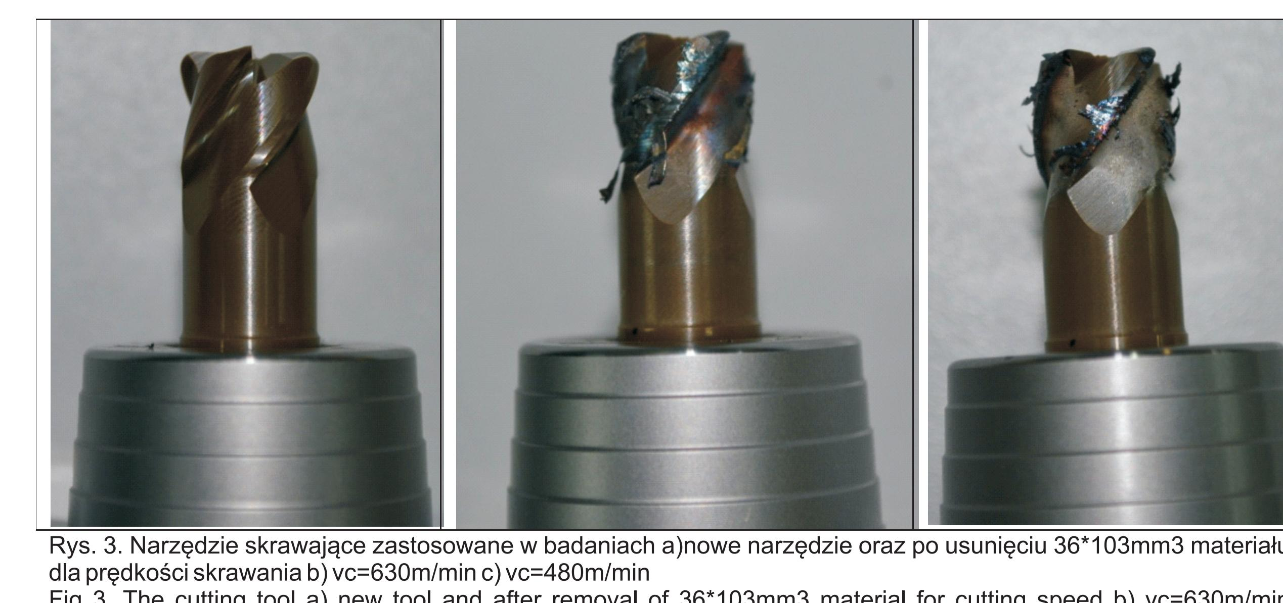
Rys. 3. Narzędzie skrawające zastosowane w badaniach a) nowe narzędzie oraz po usunięciu 36\*103mm3 materiału
